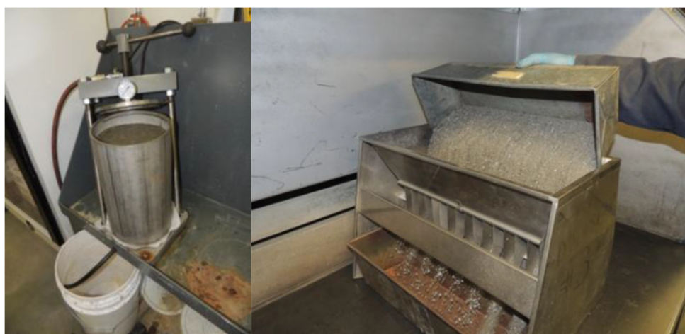
Figure 3-3 : Filtre-presse (à gauche) et diviseur de particules (à droite)
