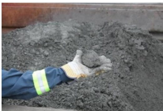
Figure 3-31 : Test de cohésion « terrain » pour le paste rock
