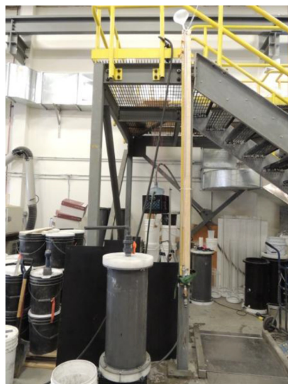
Figure 3-9 : Essai de perméabilité pour le paste rock
