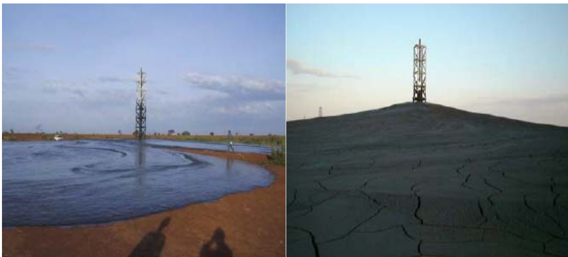
Figure 2.9. Écoulement des résidus miniers en pâte au début de la déposition en surface (gauche) et progression de la déposition formant un cône autour d'une tour de dépôt (droite) (adaptée de Theriault, 2003)
