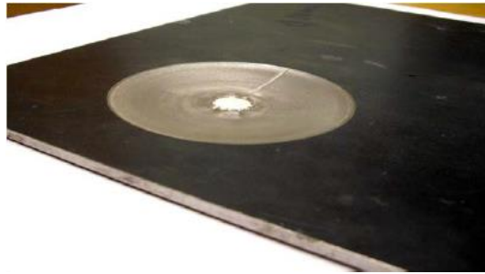
Figure 2.15 TNA à deux degrés de liberté pour des ondes de flexion dans une plaque [36].
