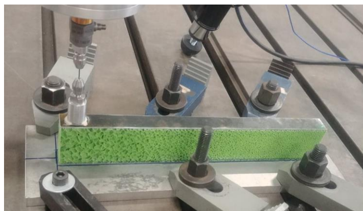
Figure 6.7 Poutre sandwich encastrée sur la peau inférieure avec une âme de raideur variable
