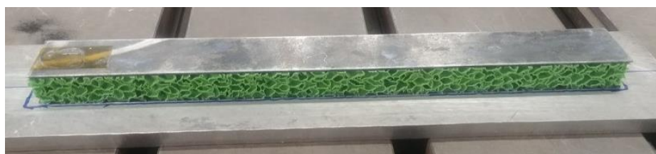
Figure 5.19 Dispositif expérimental pour la caractérisation inverse des propriétés viscoélastiques du matériau architecturé à 10% de remplissage
