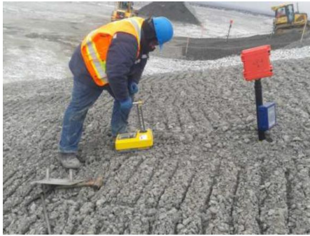
Figure 4.7: Mesure de la masse volumique sèche en place avec un nucléodensimètre (Awoh et al. 2016)
