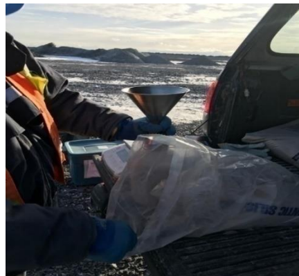
Figure 4.18 : Pesée effectuée lors d'un essai au cône de sable
