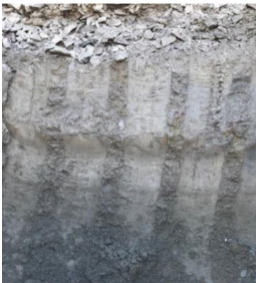
Figure 4.17 : Couche de rétention d'eau de la cellule CS2 (photo prise dans une des tranchées effectuées lors du démantèlement)
