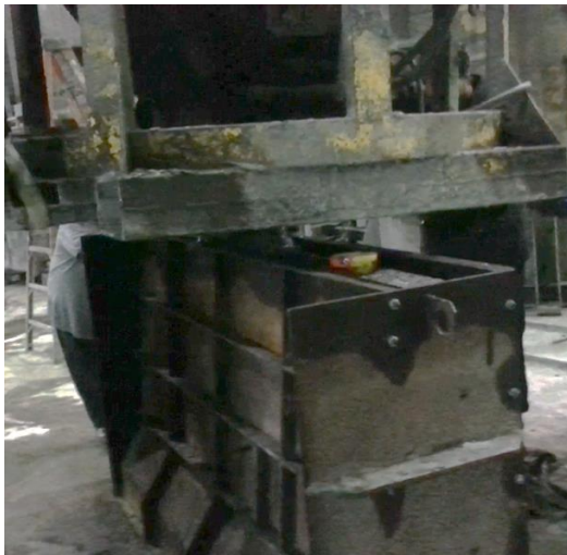
(a) Coulée de la coque en BFUP
