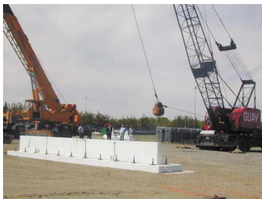
(b) Essai dynamique de pendule (El-Salakawy et al., 2004)
