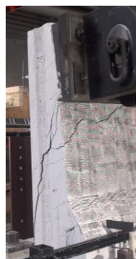
Figure 6.16 - Comparaison des plans de rupture finaux pour l'essai de chargement excentré sur parapet MTQ301 préfabriqué
