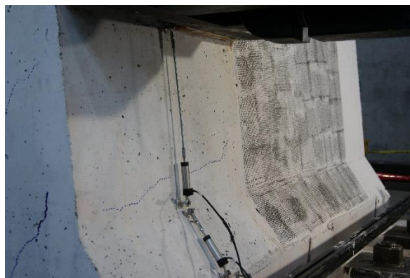
(b) Résultats expérimentaux (à 400 kN)
