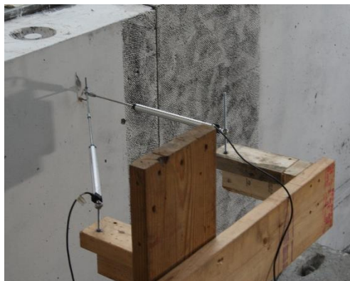
Figure 4.16 - Mesure du déplacement à l'arrière du spécimen
