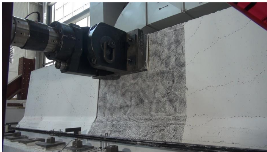
Figure 5.9 - Plan de rupture final d'une série de deux parapets MTQ301 préfabriqués soumis à un chargement excentré à l'extrémité connectée
