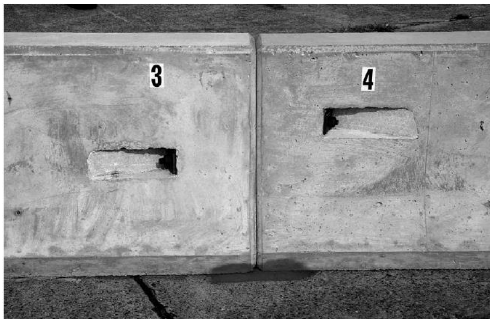
Figure 2.9 - Connexion boulonnée croisée (Bligh et al., 2003)
