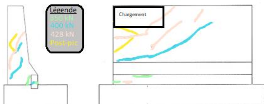
Figure 5.4 - Progression de la fissuration durant l'essai de chargement excentré sur parapet hybride de 2 m
