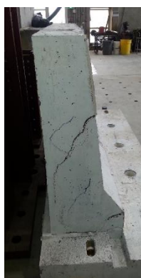
Figure 6.4 - Comparaison des plans de rupture finaux pour l'essai de chargement excentré sur parapet hybride
