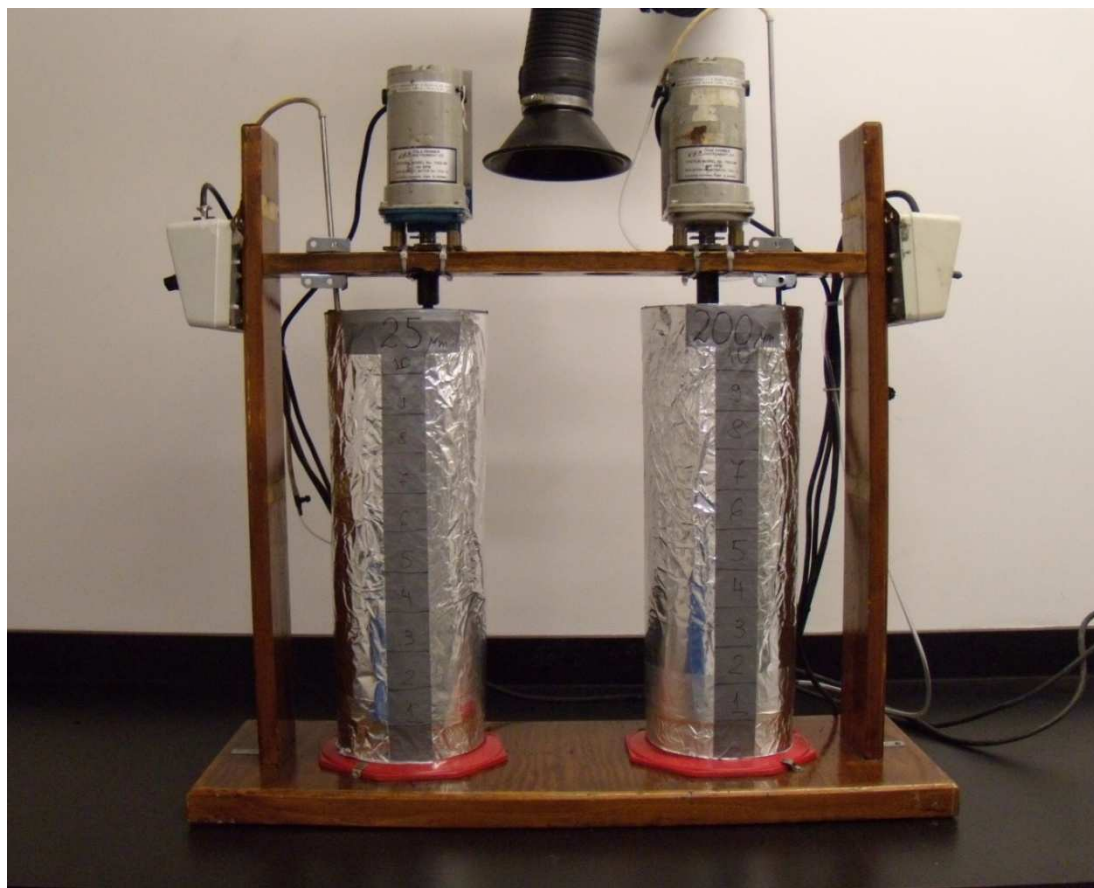
Figure 4-1. Réacteurs d'ensemencement de 25 µm (gauche) et 200 µm (droite).
