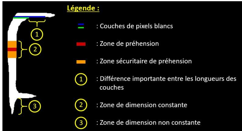
Figure 5.8 Explication des différents facteurs utilisés dans la comparaison des dimensions entre le préhenseur et l'objet
