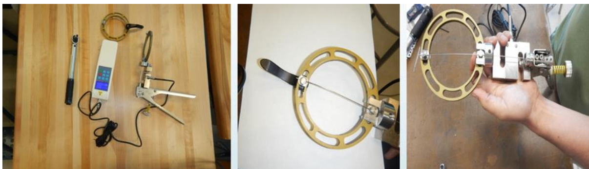
Figure 32 : Test de résistance maximale du système d'attache. (Gauche). Appareil de mesure de la charge maximale des K-wires (Dynamomètre). (Centre). Système d'attache modifié. (Droit). Système d'attache traditionnel.
