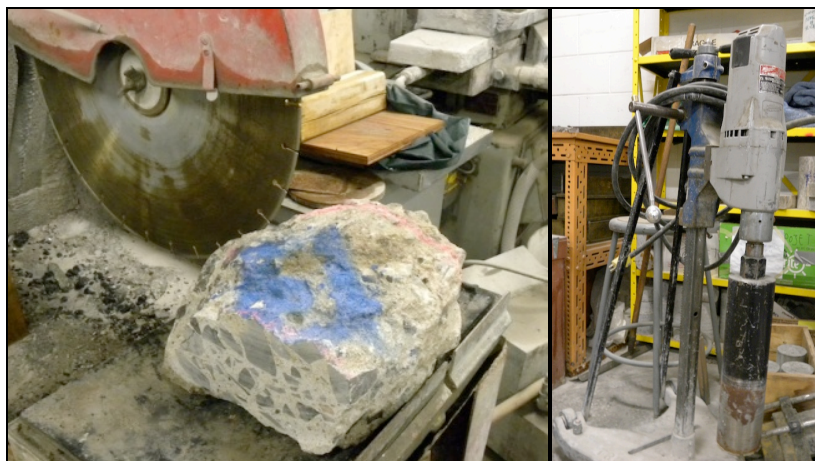
Figure 7-3: Scie à béton (à gauche) et carotteuse (à droite)
