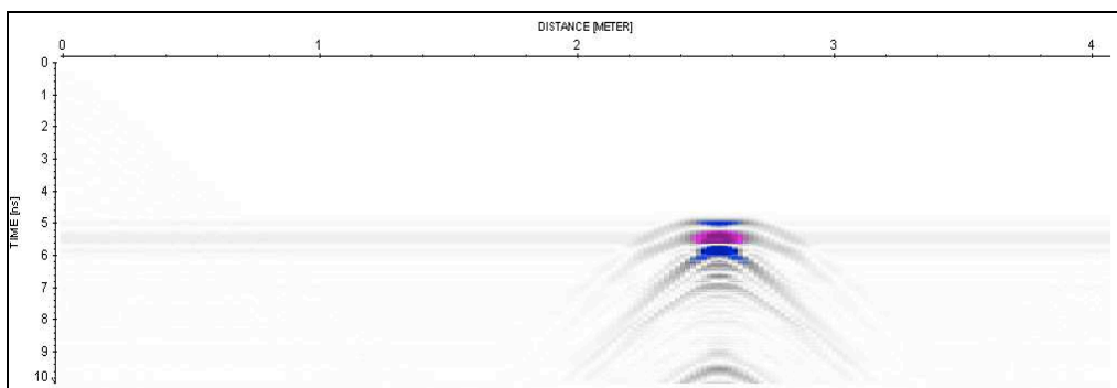
Figure C.2.7. Réponse GPR à 1GHz d'une cavité dans le haut de la fondation de 10cm de côté sans le background.
