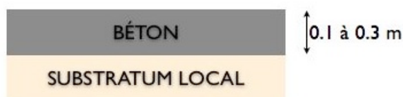
Figure 3-2: Schéma d'une chaussée rigide.
