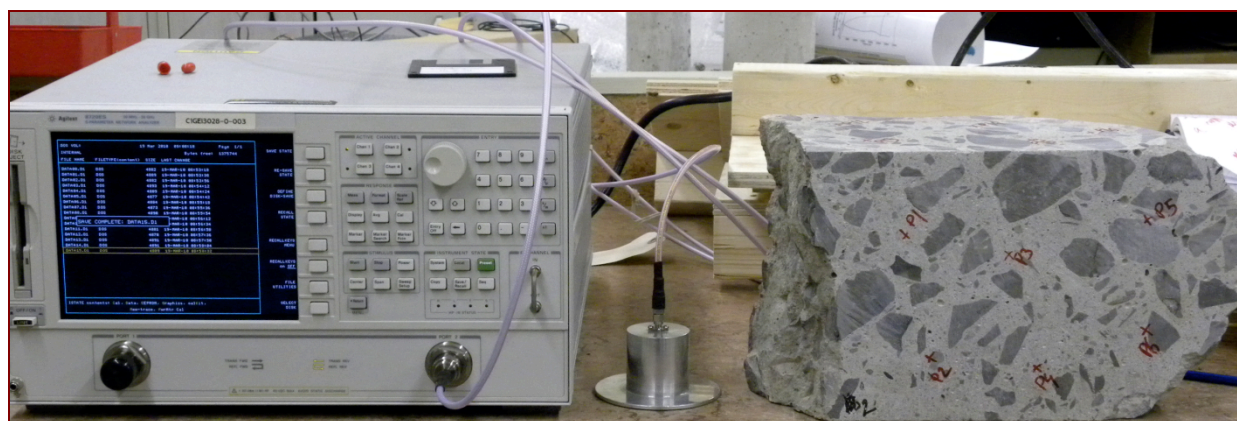
Figure 7-5: Dispositif pour mesures de permittivité complexe. De gauche à droite: VNA, sonde, bloc à ausculter.
