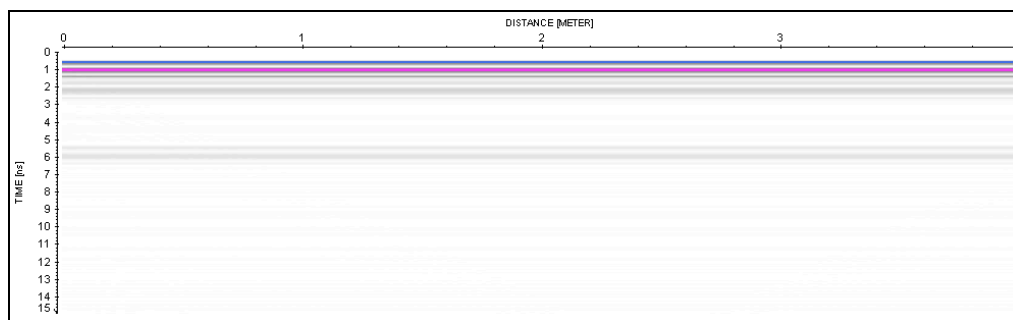
Figure A.7.6. Réponse d'une chaussée Idéale en réflexion à 1 GHz
