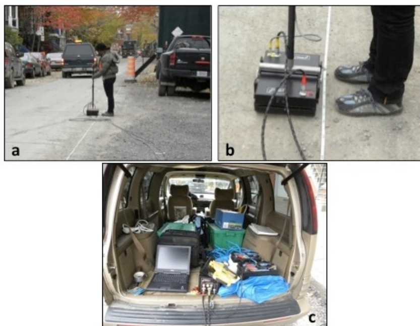
Figure 6-7: Dispositif et matériel en utilisation. a) vue d'ensemble, b) antenne et ruban-mètre, c) installation de contrôle.
