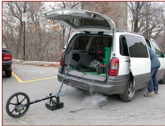
Figure 4-5: Pulse Ekko à l'arrière d'un véhicule et roue odomètre.
