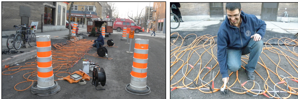
Figure 6-15: Photos de la ligne d'électrodes ( gauche : vue d'ensemble; droite : implantation des électrodes).
