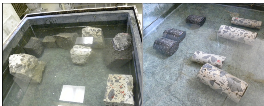
Figure 7-4: Blocs de béton plongés dans de l'eau. Sous la forme de blocs (à gauche) et sous forme de carottes (à droite).
