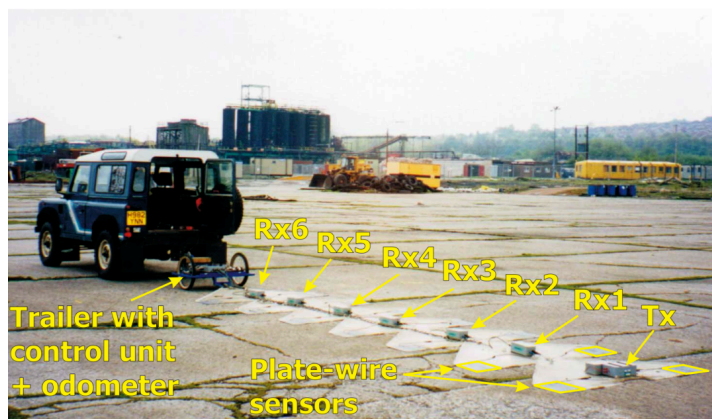
Figure 4-14: Système du BGS basé sur le CORIM en utilisation (Kuras, 2002).
