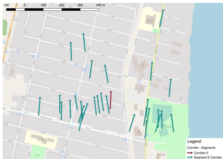
Figure 3-21: Exemple d'un corridor (0) créé à partir de segments avec Tracul_DL
