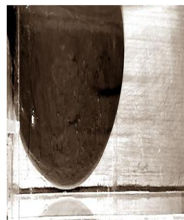
Figure 5-4 : Profil et vue en plan de l'écoulement capturé par la caméra avec une concentration de 20% et une pente horizontale.
