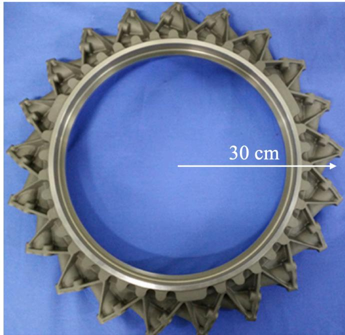
Figure 1.2 Photographie d'un diffuseur de moteur d'avion à réaction [9].
