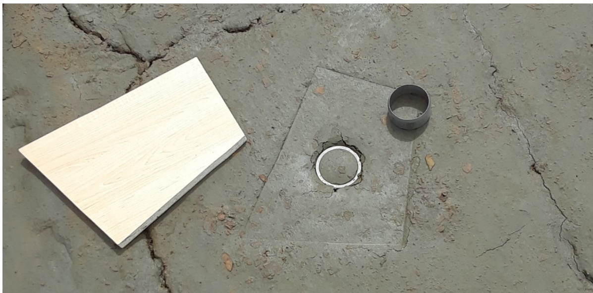
Figure 3.2 : Anneau métallique rempli de résidus miniers humides.
