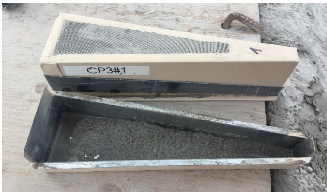
Figure 3.7 : Photographie d'un collecteur BSNE classique ayant capté des poussières (novembre 2018) après de forts vents.
