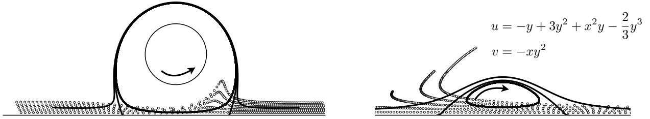
Figure 1.2 Advection de particules dans un écoulement généré par un cylindre en rotation proche de la paroi ( à gauche ), et un exemple d’une bulle de décollement ( à droite ) avec les vecteurs vitesse (u(x, y), v(x, y)) , où x est aligné avec la paroi
