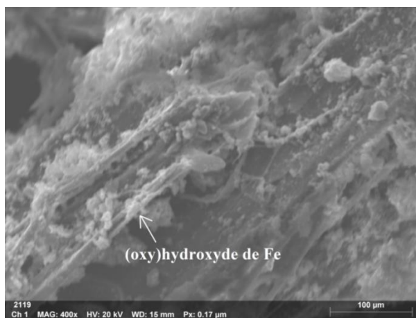
Figure 4-11 : Image MEB-EDS montrant la présence d'oxy-hydroxydes de Fe dans un échantillon de mélange réactif MR-DMA post-traitement
