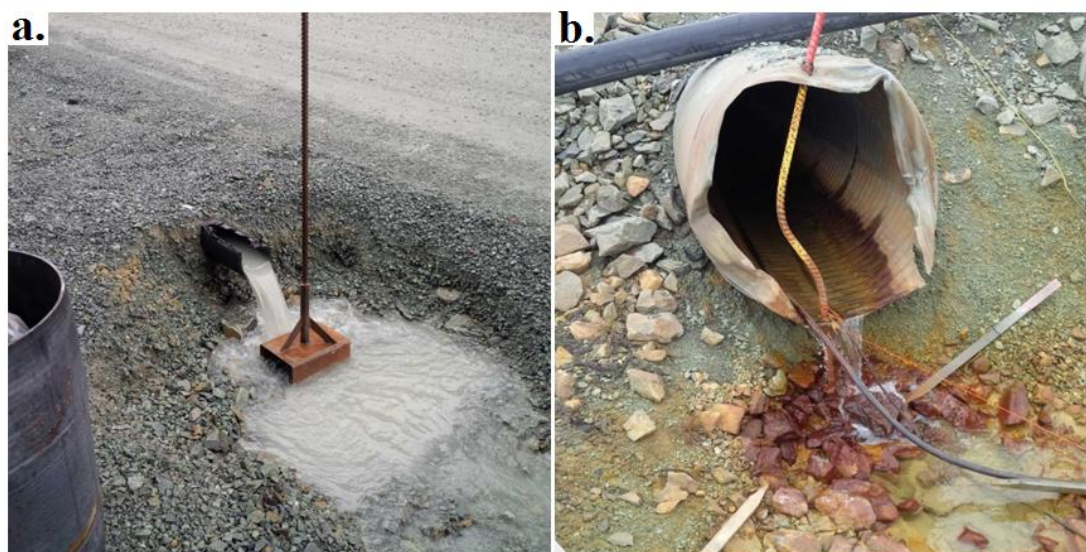
Figure 3-3 : Eau d'exhaure contaminée en Ni (a) et DMA issu du parc à résidus (b) – Mine Raglan
