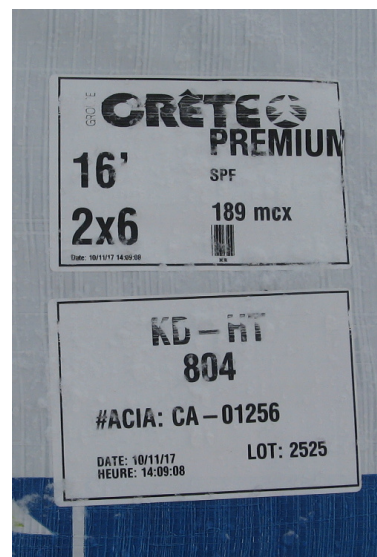
(b) Détail d'une étiquette sur un paquet de bois. On distingue par exemple la taille des morceaux, le grade Premium du bois, ou encore le numéro de lot de séchage.
