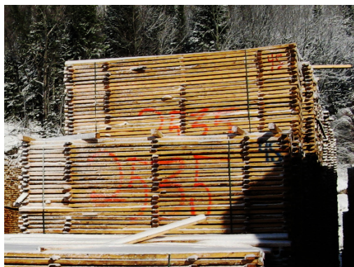
(a) Des paquets de bois séché, marqués avec le numéro du lot de séchage.
