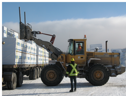
(b) Un chargeur à fourche est en train de charger des paquets de bois sur un camion de livraison.
