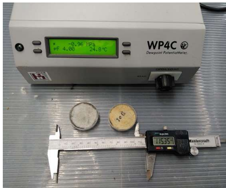
Figure 3-7 : Analyse de la succion d'échantillon de GCB à l'aide d'un WP4C (LGEUC)
