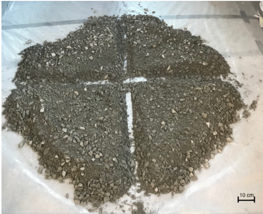
Figure 3.3: Exemple d'une étape de la séparation de l'échantillon CCM-1 par quartage.
