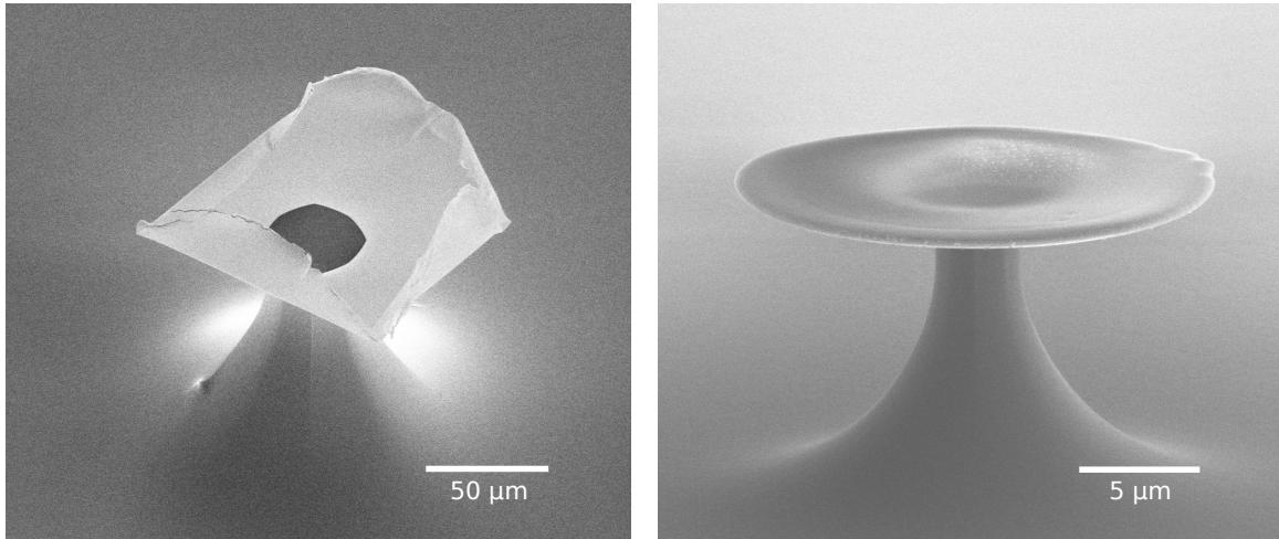
(a) Effet de repliement du disque causé par une sous-gravure trop élevée ( $> 30 \mu\text{m}$ ).
