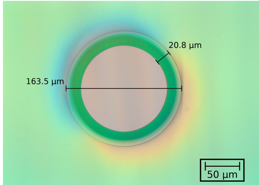
Figure 3.7 Image prise au microscope optique d'une cavité ayant un diamètre de 163.5  $\mu\text{m}$  et une sous-gravure de 20.8  $\mu\text{m}$  obtenue après une gravure isotrope de 10 minutes. Il est possible de voir à travers le SU-8 pour observer la taille du pilier de silicium.
