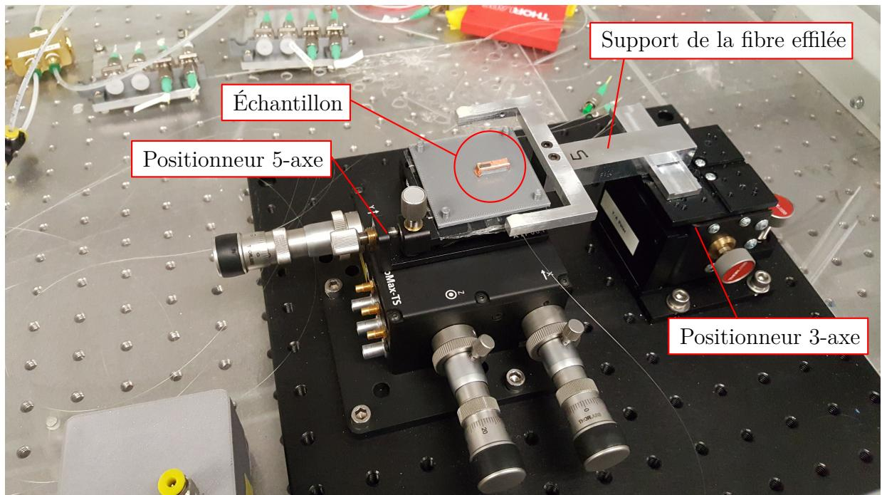
Figure 3.12 Montage de couplage de microcavité avec une fibre effilée. L'échantillon est fixé sur un positionneur à 5 axes et le support de la fibre effilée sur un support à 3 axes. Ce montage est placé à l'intérieur d'une boîte en acrylique pouvant être scellée pour effectuer des expériences avec des gaz.
