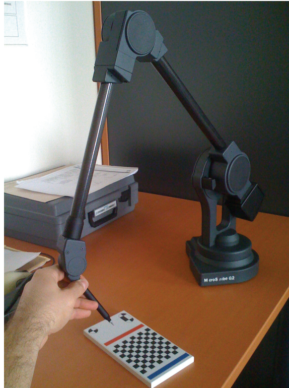
Figure 2.15. MicroScribe utilisé pour numériser l'objet de calibrage
