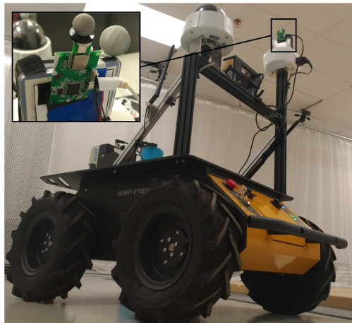
Figure C.1 Robot Husky© et carte UWB utilisée.
