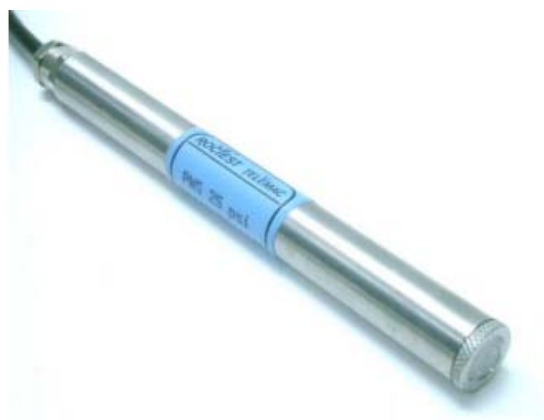
Figure 3–12 Piézomètre à corde vibrante (tiré de Roctest)
