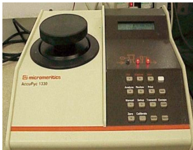
Figure 3–3 Pycnomètre à hélium AccuPyc 1330 de Micromeritics®
