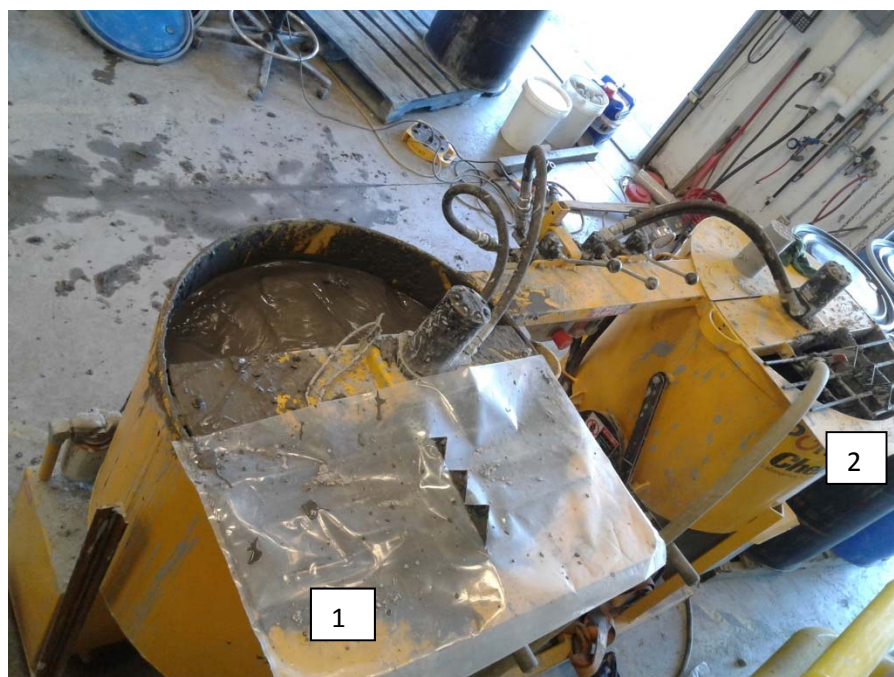
Figure 3–25 Préparation du remblai dans le mélangeur-pompe
