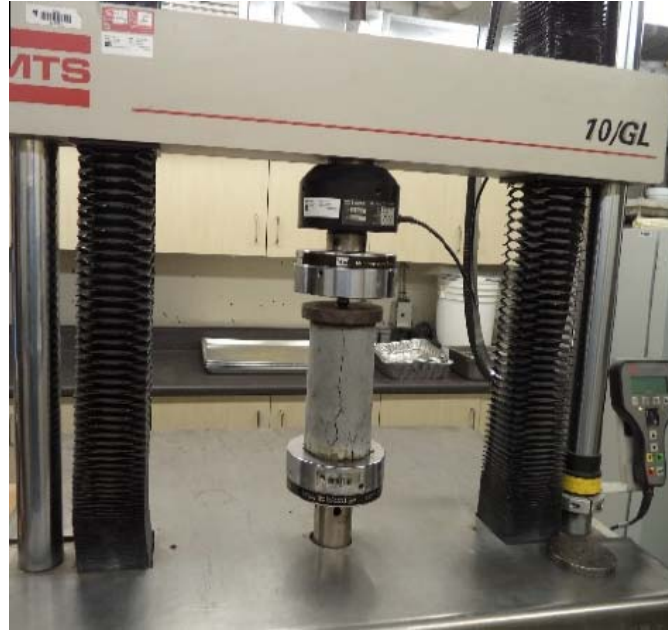
Figure 2–29 Illustration d'un test de compression uniaxiale au laboratoire
