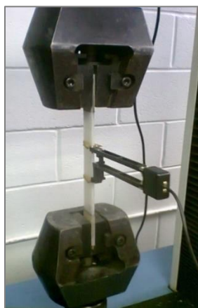
Figure 3.14: Mesure des déformations longitudinales par un extensomètre
