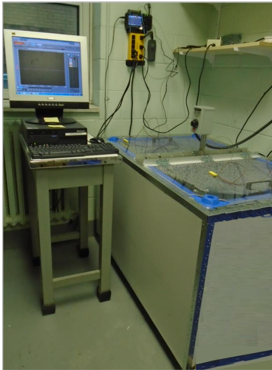
b) Le bain de vieillissement accéléré et son système d'acquisition
