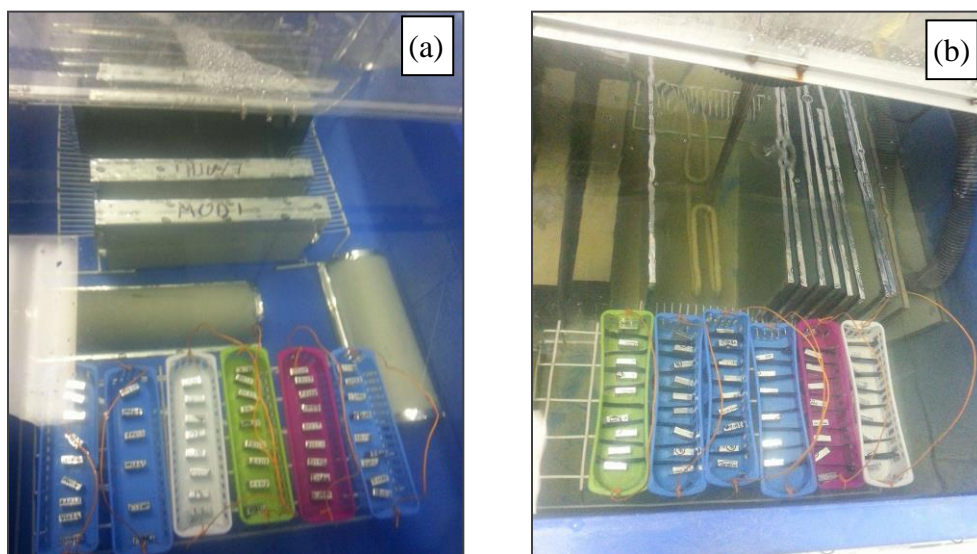
Figure 3.13: Bains de vieillissement : (a) à température ambiante ( T_{\text{amb}} ); (b) vieillissement accéléré à T=40^{\circ}\text{C}
