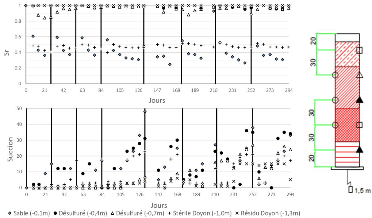
Figure C.3 : Degrés de saturation et succion mesurés dans la colonne C3
