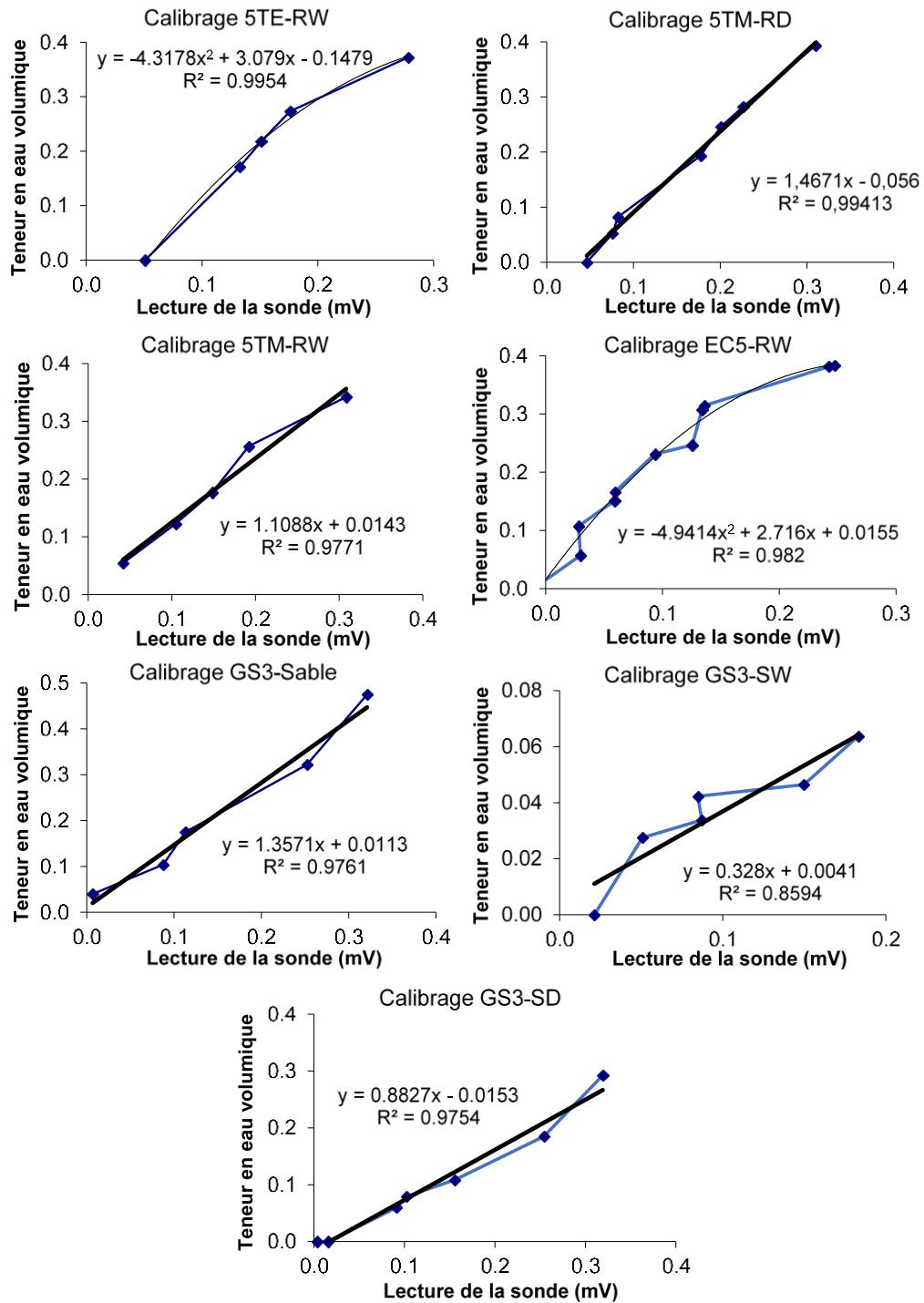
Figure 3.13 : Courbes de calibrage des sondes ECH2O pour les matériaux étudiés
