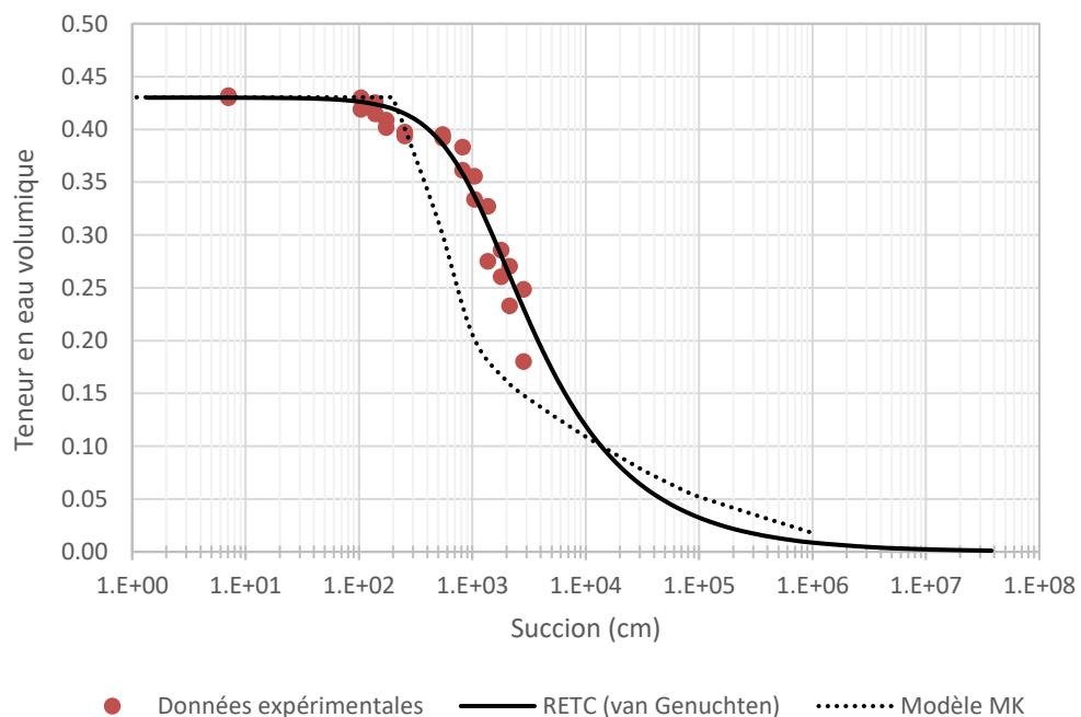
Figure 3.5 : Courbe de rétention d'eau du résidu Doyon
