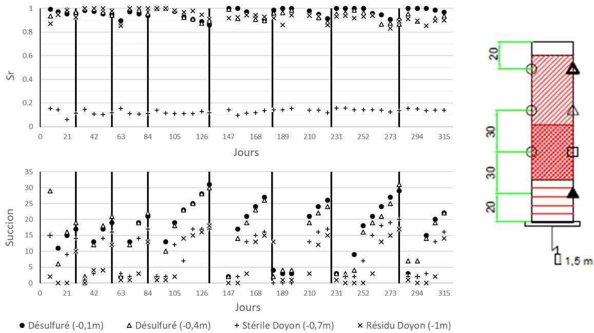
Figure C.1 : Degrés de saturation et succion mesurés dans la colonne C1
