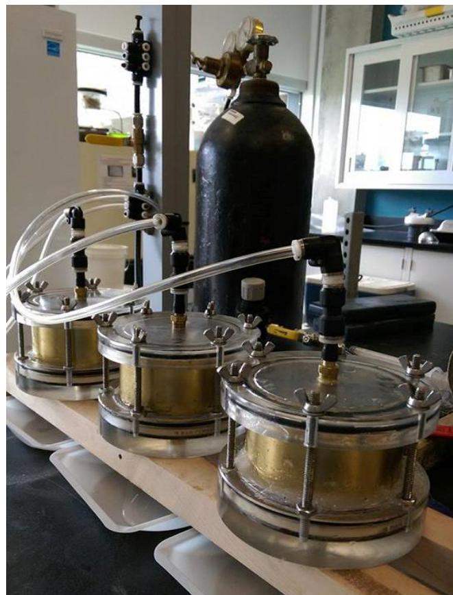
Figure 3.4 : Cellules de Tempe utilisées et aperçu du montage
