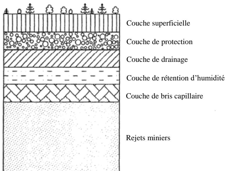
Figure 1.1 : Cinq couches principales d'une CEBC (adapté de Aubertin et al. 1995)
