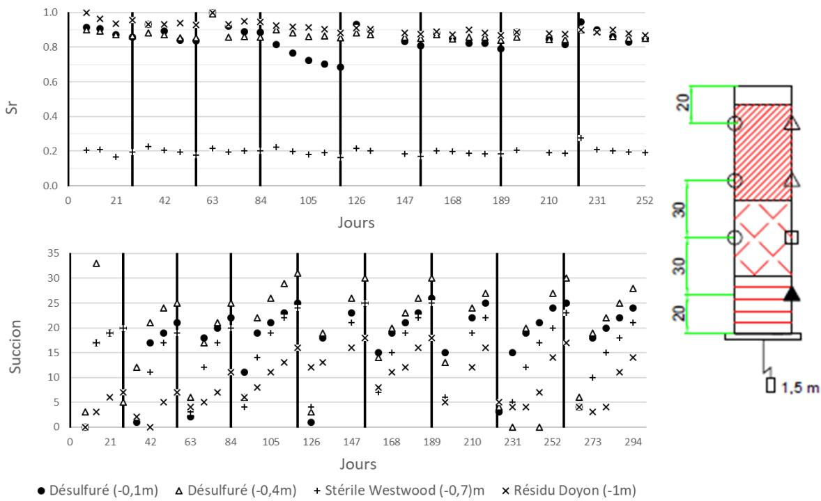
Figure C.2 : Degrés de saturation et succion mesurés dans la colonne C2
