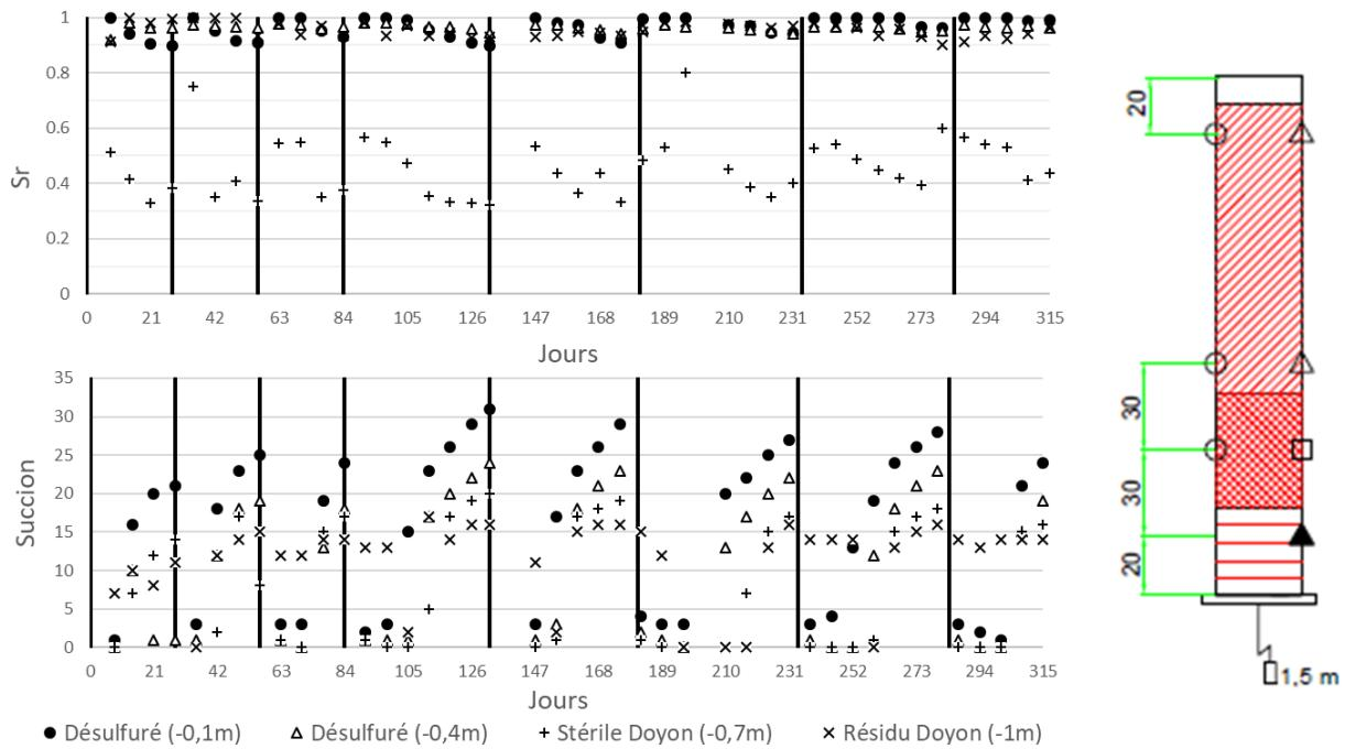
Figure C.4 : Degrés de saturation et succion mesurés dans la colonne C4
