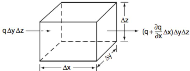
Figure 2.2 : Principe de continuité dans un élément sol non-saturé (adapté de Hillel, 2004)
