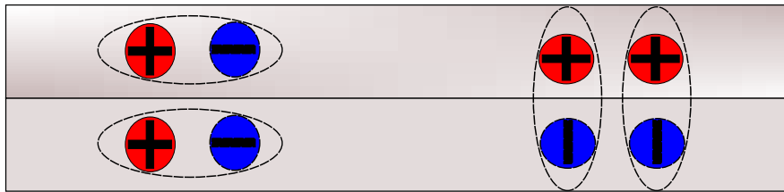
Figure 5.1 Excitons intra-couche (gauche) et inter-couche (droite). Les deux types d'excitons sont modélisés par des dipôles horizontaux et verticaux respectivement.
