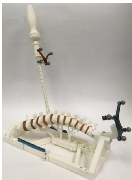
Figure 5.11 Fantôme et tournevis utilisés pour faire les expériences avec le navigateur
