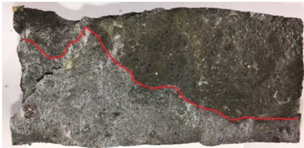
Figure 4-19: Profil de pénétration des chlorures dans le spécimen en BO 2 avec la face truellée exposée aux chlorures
