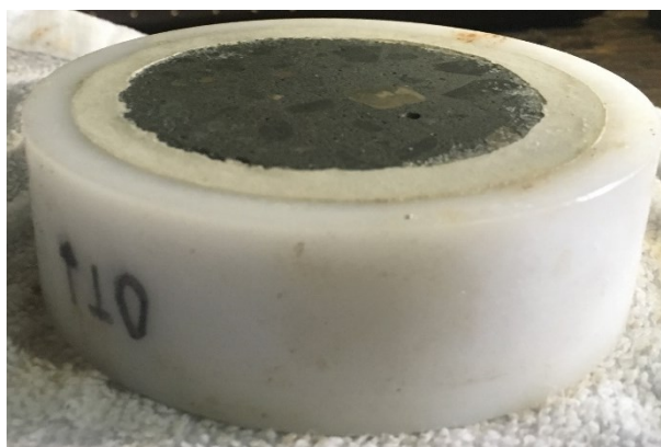
Figure 3-11: Spécimens utilisés pour l'essai de migration des chlorures
