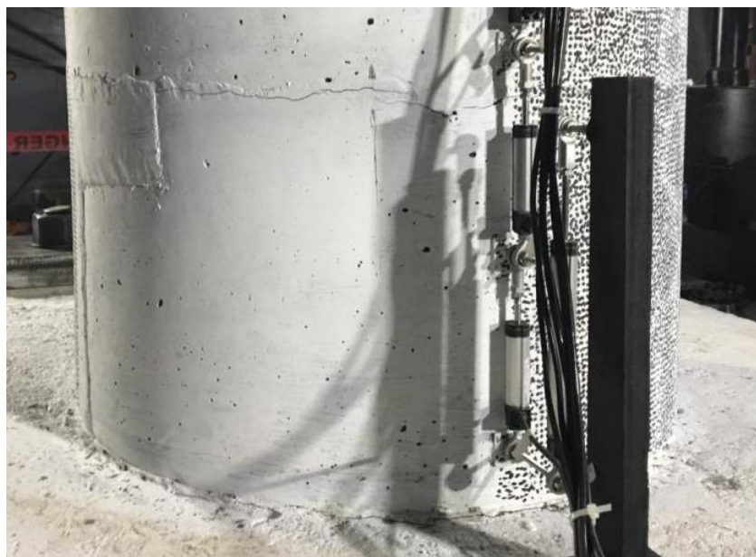
Figure 4-34 : Soulèvement et fissuration du pré-chargement pour la colonne de préfabriquée
