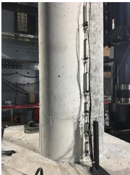
Figure 4-35 : Dégradation globale du spécimen préfabriqué à la première plastification
