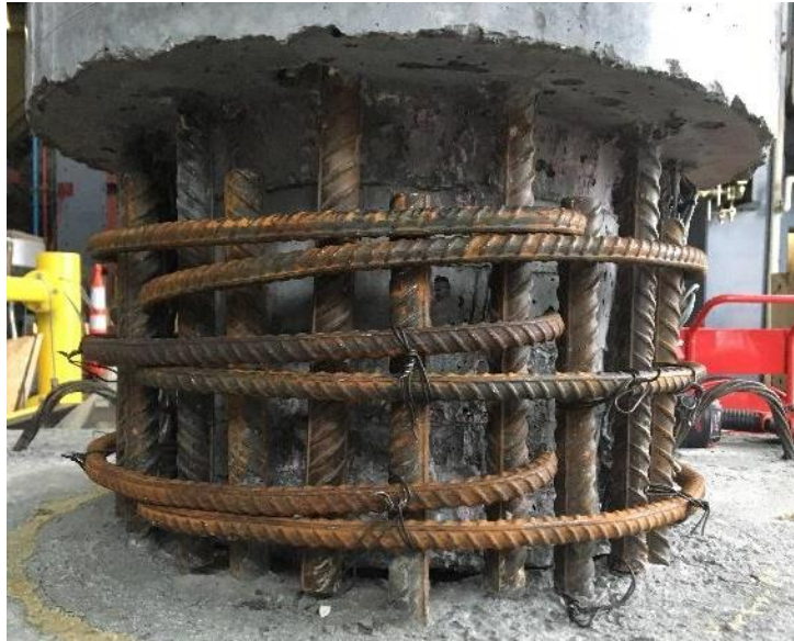
Figure 4-11 : Positionnement de l'armature du joint en BFUP
