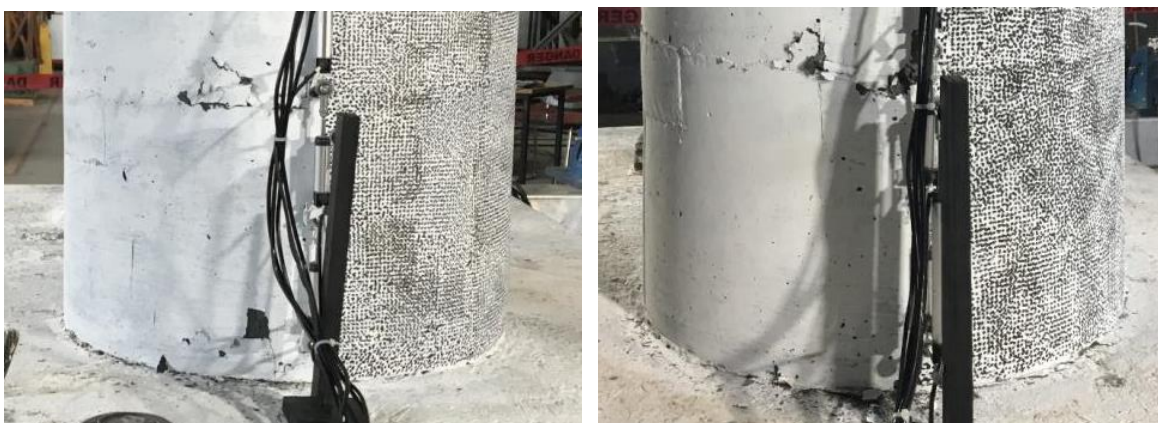
Figure 4-37 : Dégradation du joint du spécimen préfabriqué pour 3\Delta y
