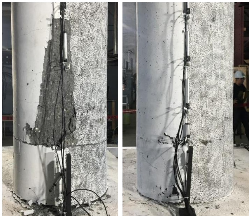
Figure 4-42 : Dégradation globale du spécimen préfabriqué pour 5 \Delta y
