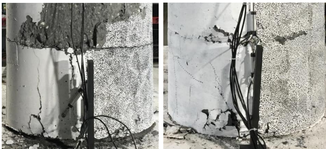
Figure 4-45 : Dégradation à la base du spécimen préfabriqué pour 7\Delta y
