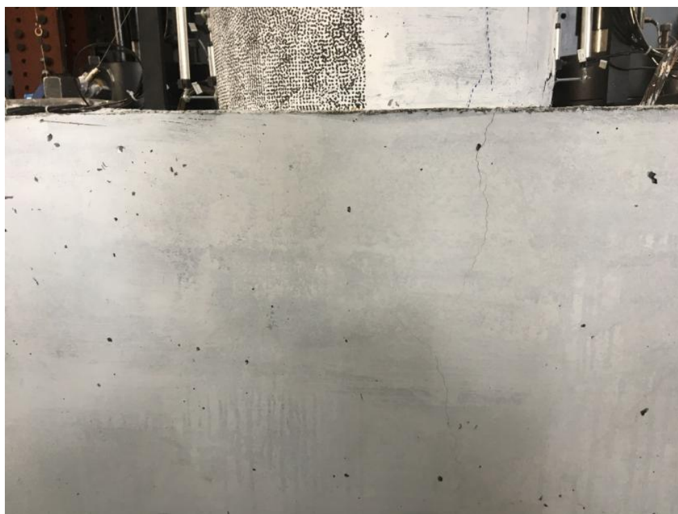
Figure 4-41 : Fissures dans la semelle pour 4 \Delta y
