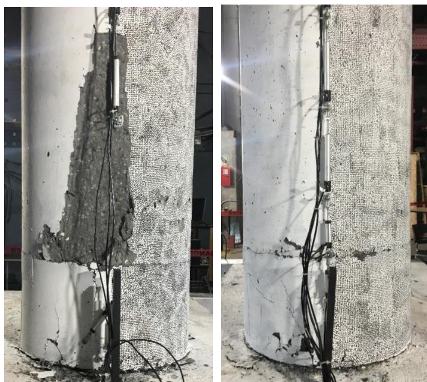
Figure 4-43 : Dégradation globale du spécimen préfabriqué pour 6 \Delta y
