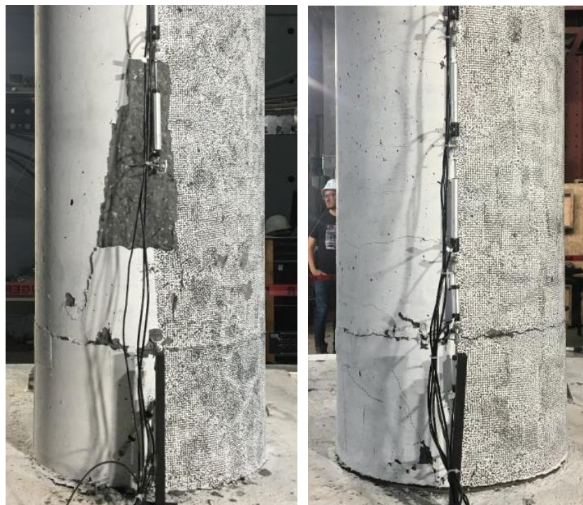
Figure 4-39 : Dégradation globale du spécimen préfabriqué pour 4\Delta y
