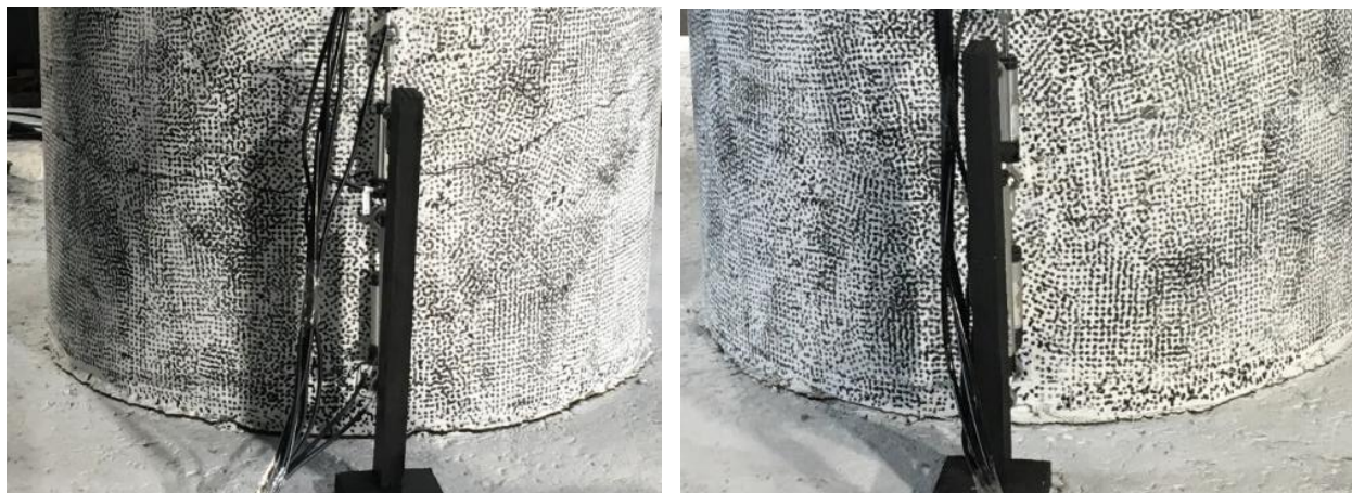
Figure 4-26 : Soulèvement et fissuration du pré-chargement pour la colonne de référence
