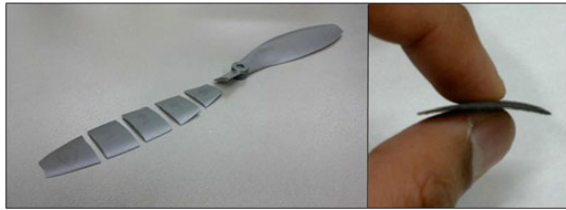
(a) Coupes de l'hélice (gauche) vue de coupe (droite)
