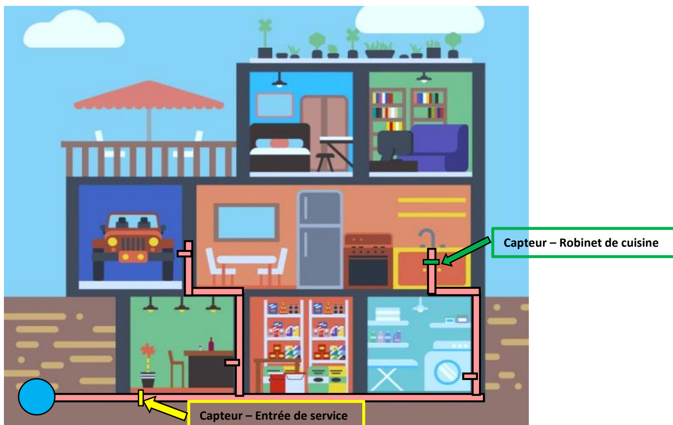
Figure B - 5 : Schéma d'implantation des capteurs de température (source photo : freepik.com)
