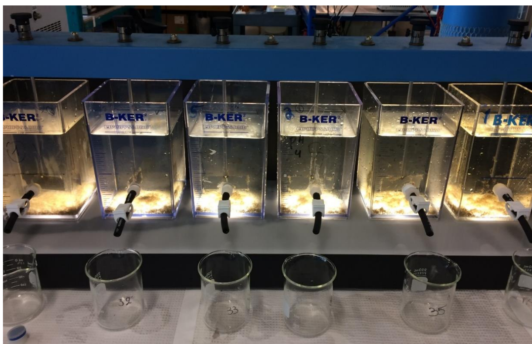
Figure 5-18: Réalisation des jar test
