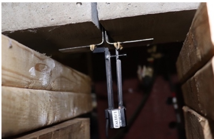
Figure 4-19 : Clip gage en place sur la poutre RILEM 1
