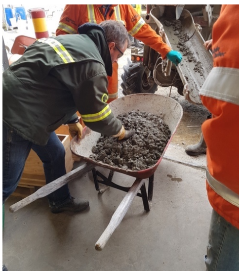
(a) Extraction d'une petite quantité de béton
