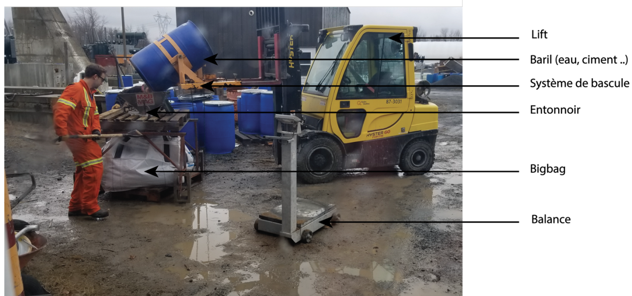
Figure 3-11 : Réalisation d'une pesée
