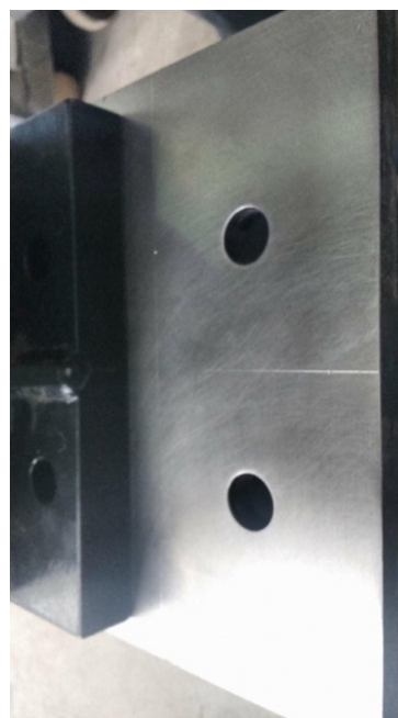
(b) Marquage au poinçon de la poutre rigide et des couteaux pour centrage
