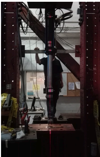
(a) Mise en position du laser par rapport au vérin
