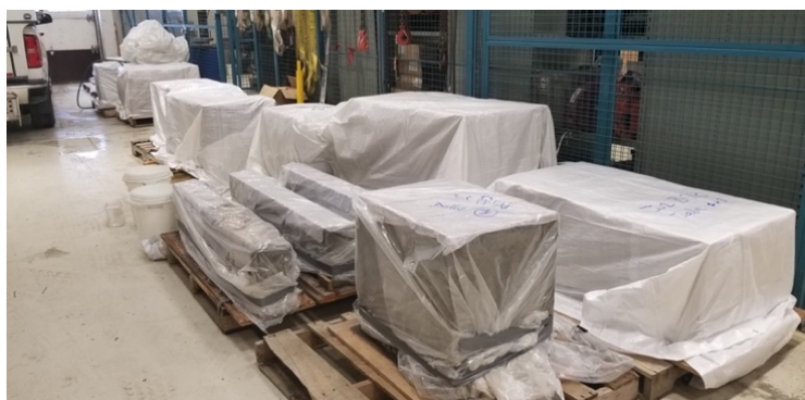
Figure 3-18 : Entreposage sous bâches et toiles de jutes des spécimens en post-coulée
