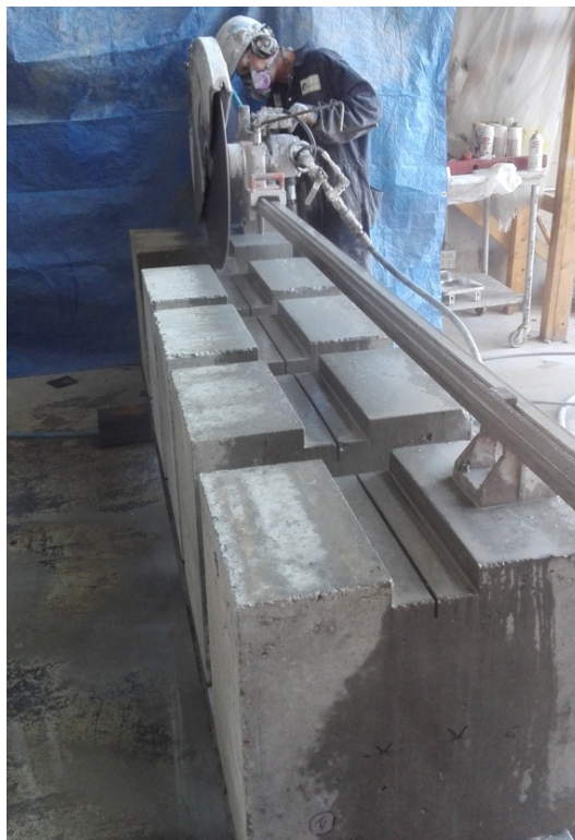
Figure 3-27 : Sciage de blocs WST 76mm
