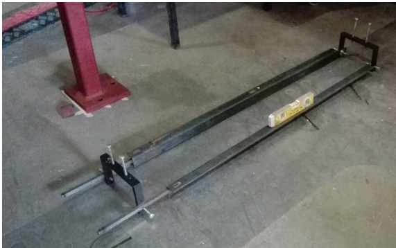
(a) Système de mesure de flèche seul
