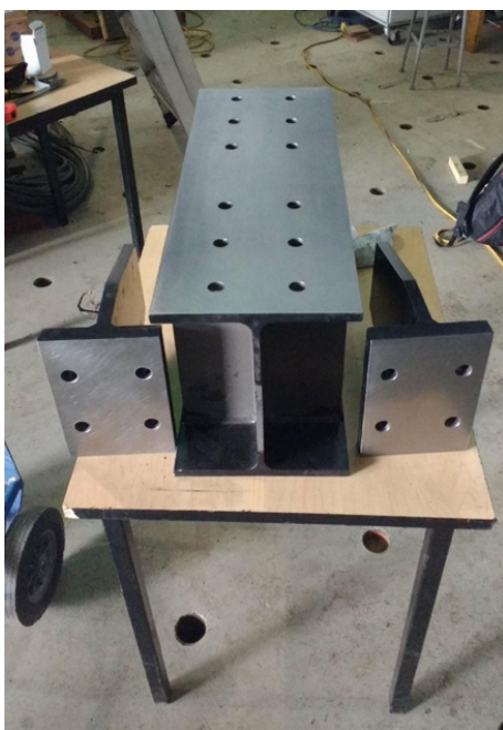
(a) Couteaux et poutre rigide disposés l'un à côté de l'autre
