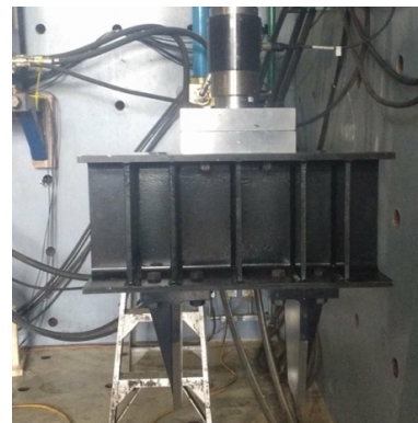
(b) Vérin – Plaque de transmission des efforts – Poutre de transmissions des efforts – couteaux
