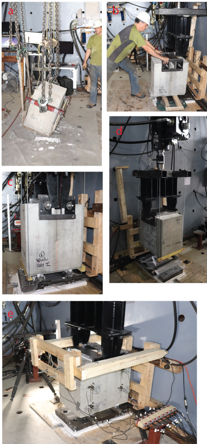
Figure 4-22 : Protocole expérimental illustré pour test de fendage pour bloc WST 76 mm
