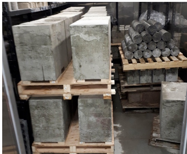
Figure 3-23 : Entreposage en salle 100% d'humidité
