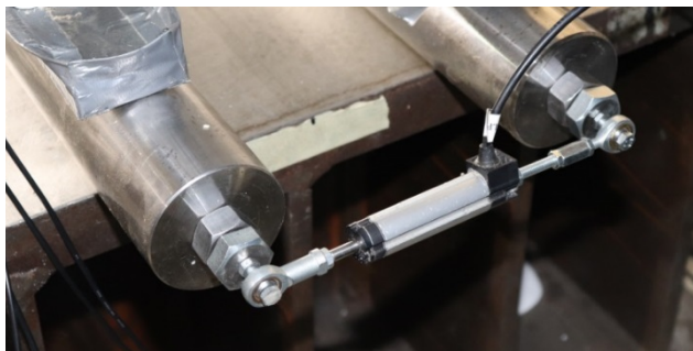
Figure 4-9: LVDT entre les axes des appuis
