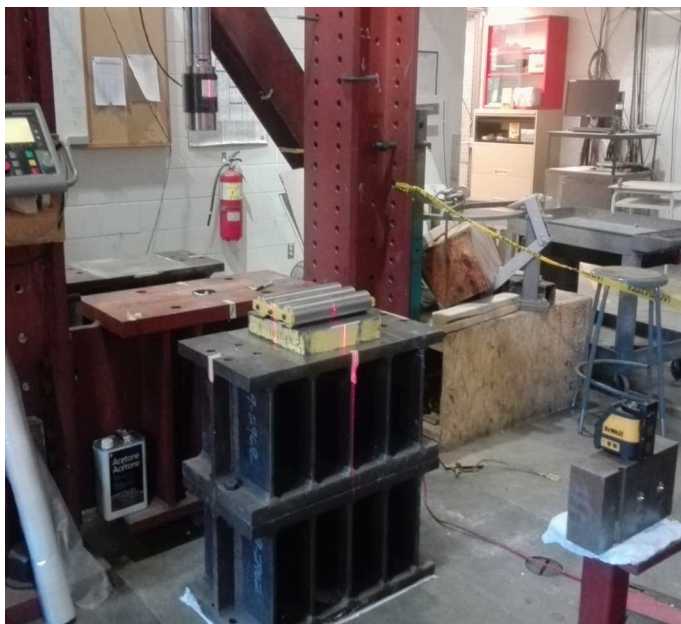
(b) Centrage de l'appui par le laser
