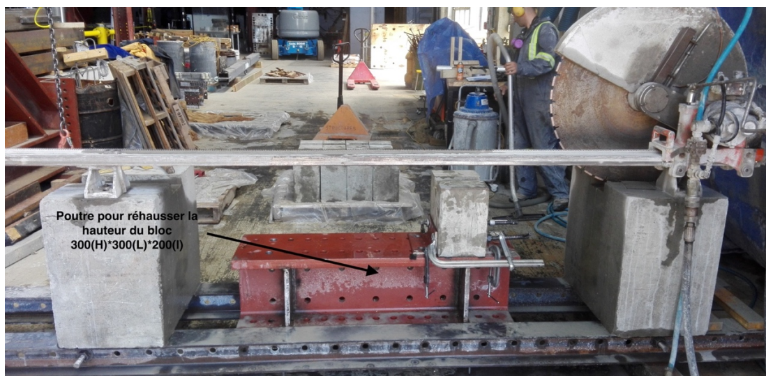
Figure 3-26 : Sciage d'un bloc WST 38mm avec poutre de rehaussement
