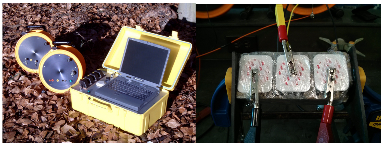
Figure 33 : (gauche) Instrument de mesure pour la conductivité complexe spectrale SIP FUCHS III (Radiac Research); (droite) Demi-carotte avec électrodes de mesure de tension.
