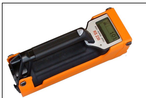
Figure 41 : Spectromètre gamma RS-230 de la compagnie RSI (Radiation Solutions Inc.)
