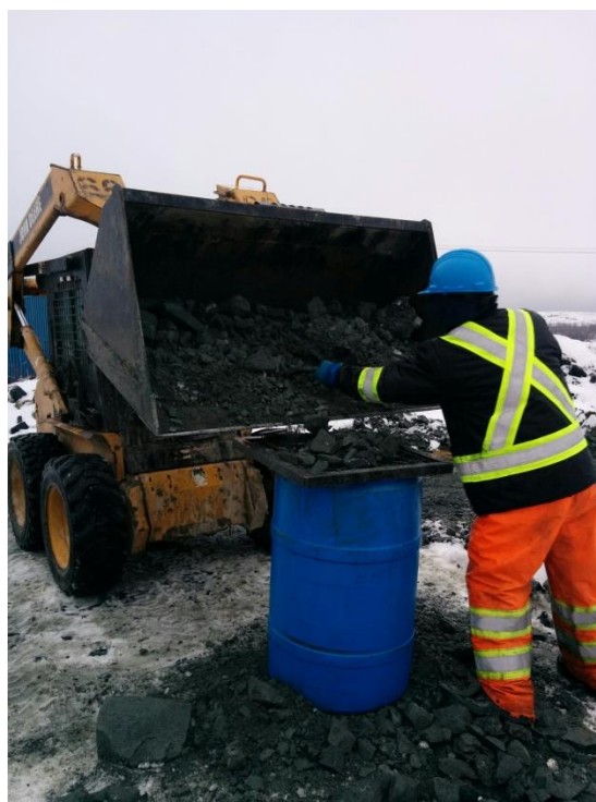
Figure 3- 2 : Échantillonnage des stériles miniers
