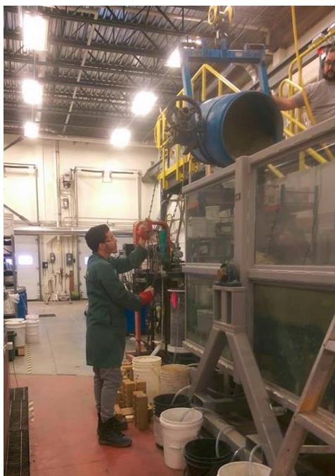
Figure 3- 25 : La mise en place des couches des matériaux dans le modèle physique
