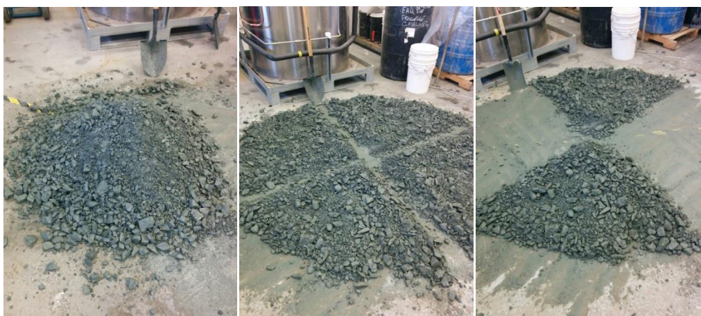
Figure 3- 3 : Homogénéisation des stériles par quartage
