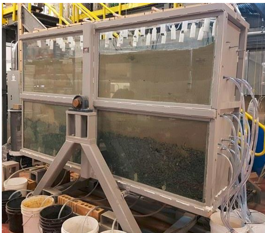
Figure 3- 26 : Récupération des eaux sortantes de la boîte dans des chaudières
