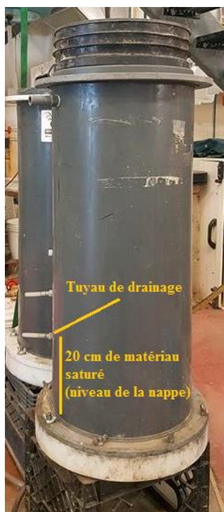
Figure 3- 4: Colonne pour la mesure de la CRE
