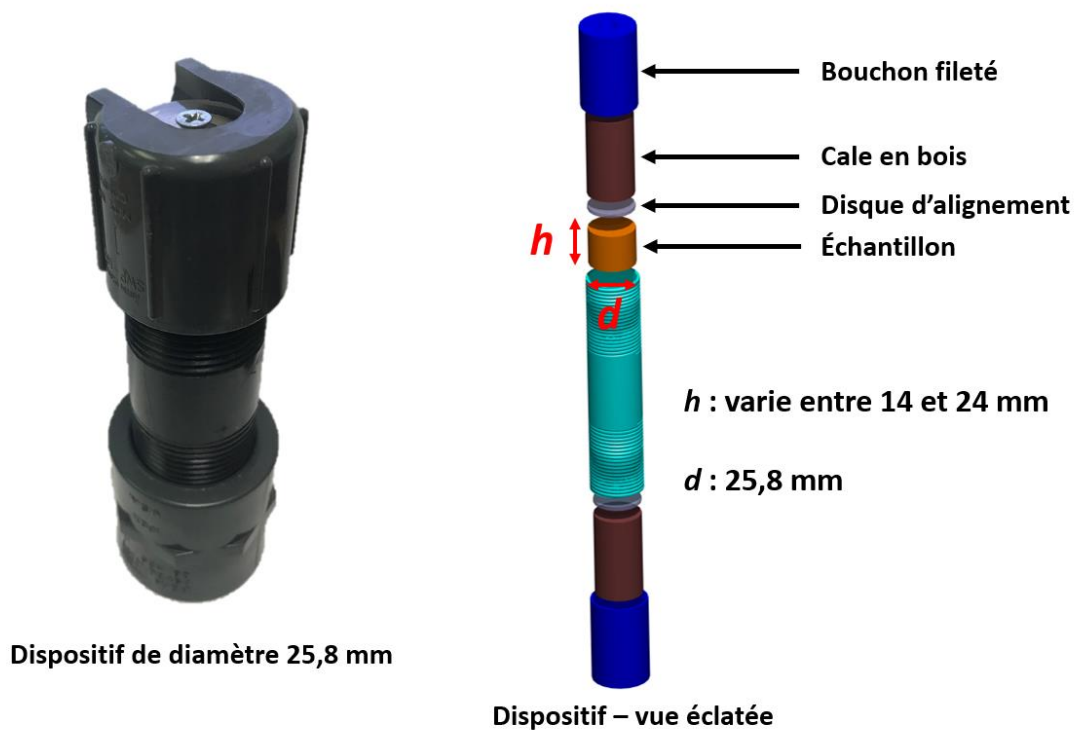
Figure 4.1 : Représentation schématique du dispositif de diamètre intérieur 25,8 mm
