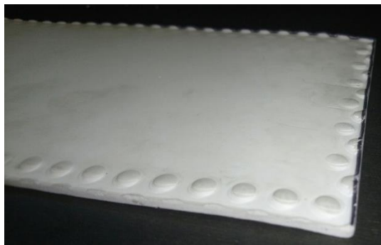
Figure 8-4 : Filtre Porex PM-0130 présentant une déformation et un endommagement de son réseau poral après une série de filtrations comme le montre le pourtour du filtre
