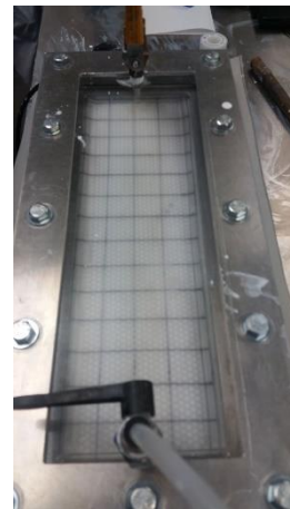
Figure 8-7 : Déformation uniforme et souhaitable d'une membrane non-renforcée en cours d'injection
