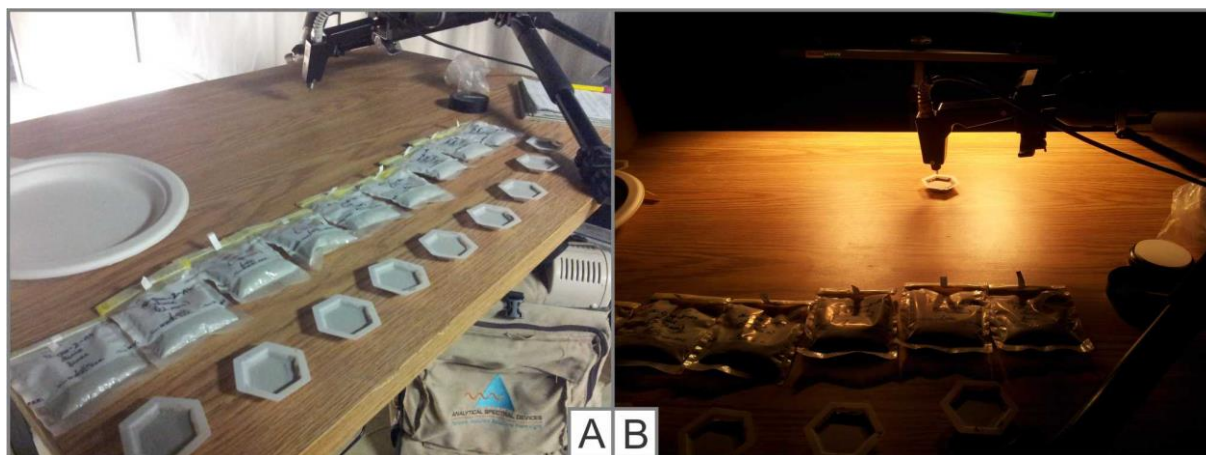
Figure 3.16 : Mise en place des échantillons dans les placettes (A) et acquisition dans la chambre noire (B)
