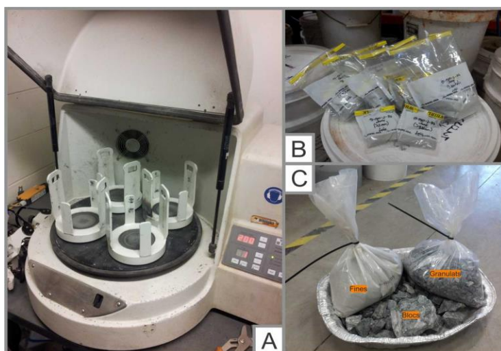
Figure 3.7 : La pulvérisette Fritsch (A), les échantillons finaux (B) et le matériel restant (C)
