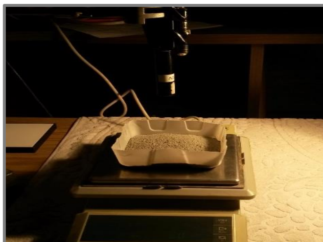
Figure 3.19 : Montage pour l'acquisition des spectres du test d'humidité
