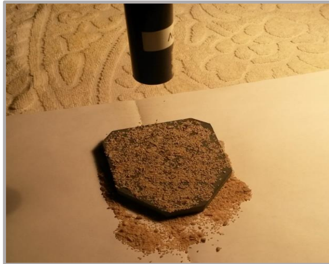
Figure 3.18 : Acquisition des poudres avec le bloc référence (plaquette) sous-jacent
