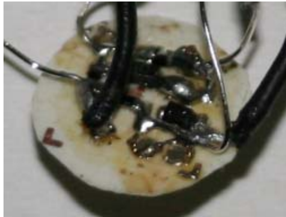
Figure 5-5 : Photographie du circuit électronique passif dont le diamètre est moins de 8 mm.
