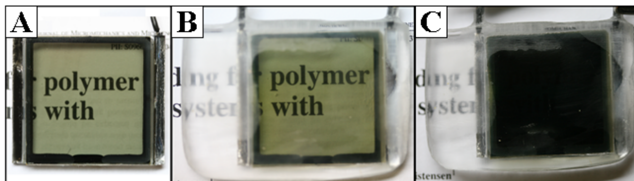
Figure 5-2 : A : CCL seule. B : CCL qui a survécu au processus de fabrication de la prothèse oculaire, avec la CCL à l'état allumé. C : CCL à l'état éteint, montrant l'uniformité et le contraste.
