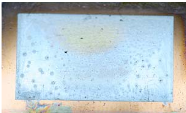
Figure 8-7: Dépôt d'une couche mince d'oxyde de titane sur les micromiroirs, donnant une apparence bleutée.
