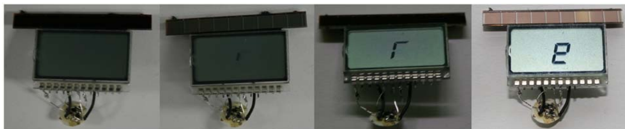
Figure 5-4 : Démonstration du circuit passif. La luminosité ambiante augmente de gauche à droite et chaque segment activé représente la diminution du diamètre de la pupille. Le dispositif est entièrement autoalimenté et autonome.
