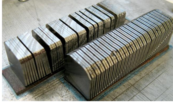
Figure 2.2 Échantillons carrés de 1 mm d'épaisseur et de 20 mm d'arête coupés par la scie radiale Diamond Touch.
