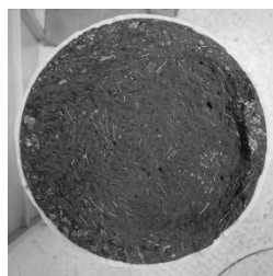
c) Surface de rupture supérieure (côté éprouvette)
