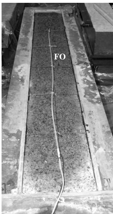
Figure 6.6 Surface hydrodémolie d'une poutre avant la réparation
