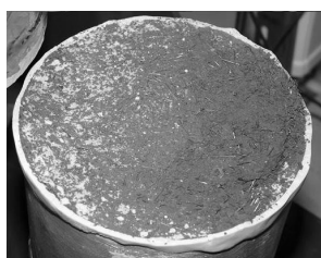
b) Surface inférieure de la rupture (côté casque)
