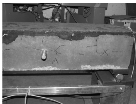
Figure 6.7 Montage pour l'étude du comportement déformationnel d'une poutre réparée
