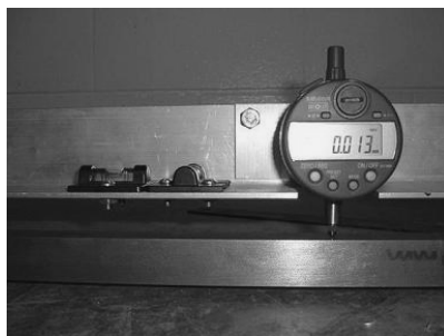
a) extensomètre sur la barre de référence
