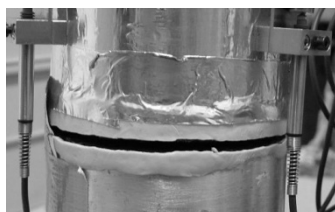
a) rupture à la base de l'éprouvette
