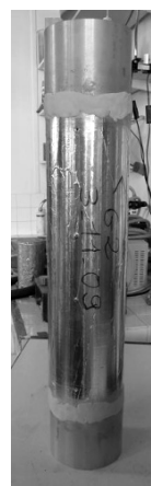
b) Casques sur l'éprouvette
