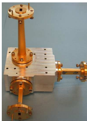
Figure 6.38: Premier montage pour la mesure des adaptations aux sorties de l'OMT (ports 2 et 3) et du niveau d'isolation.
