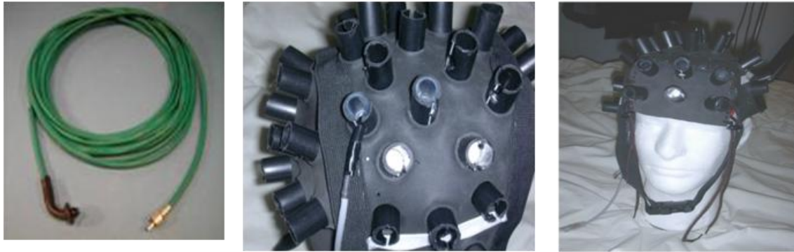
Figure 2-5. Prototypé de casque SPIR. De gauche à droite : Fibres optiques utilisées et fournies par le constructeur du Techen ® CW5; Système de maintien des optodes grâce à des cylindres plastiques et un système à encoche; Aspect général du casque.
