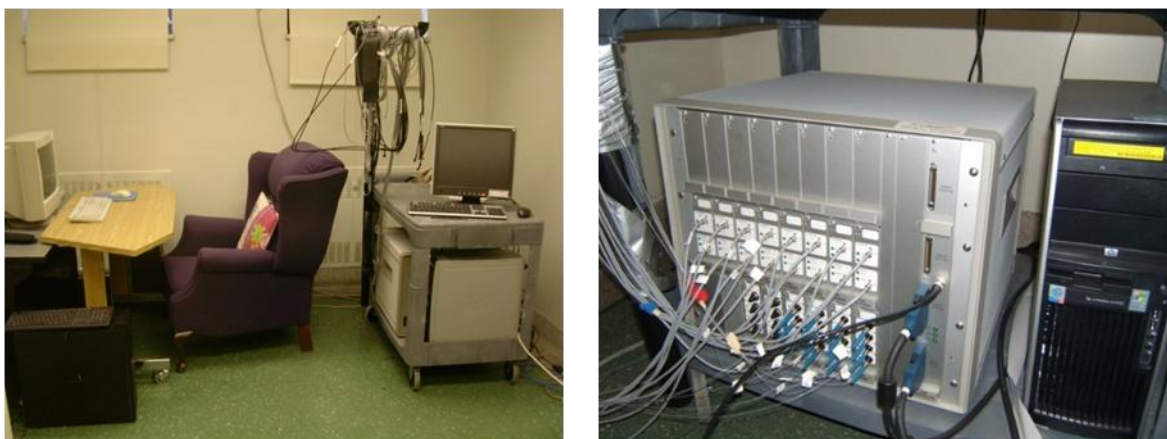
Figure 2-1. Gauche : Salle d'acquisition optique du CRIUGM ; Droite : Imageur Techen ® CW5. On retrouve les APD dans les rangées supérieures et les diodes laser dans les rangées inférieures.
