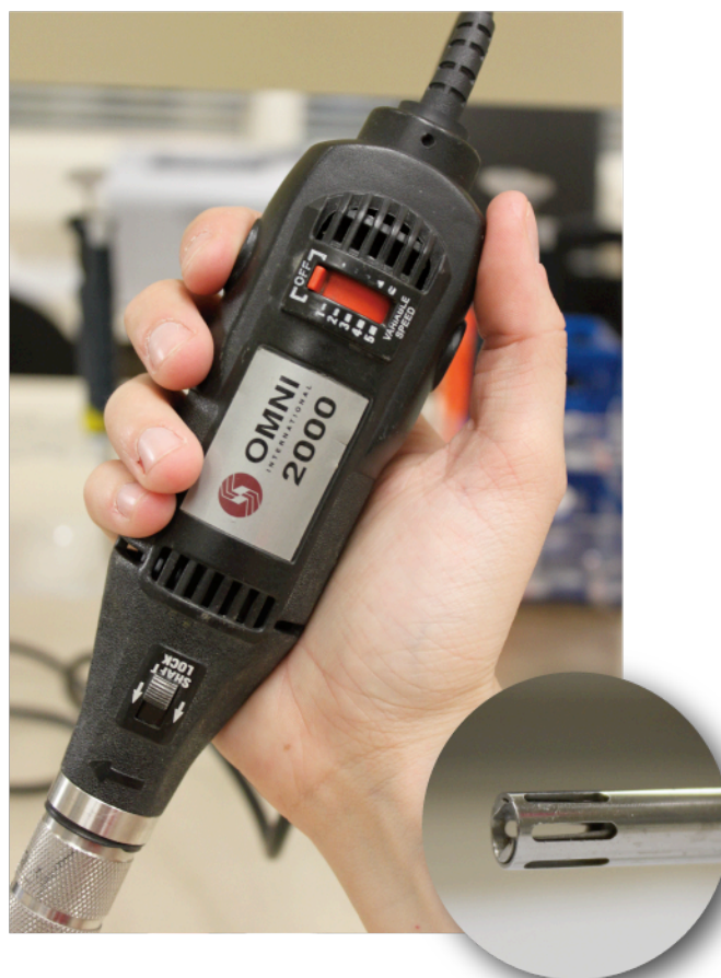
Figure 4.3 : Homogénéiseur manuel de tissus biologiques (Omni International 2000). Gros plan sur le rotor et le stator.
