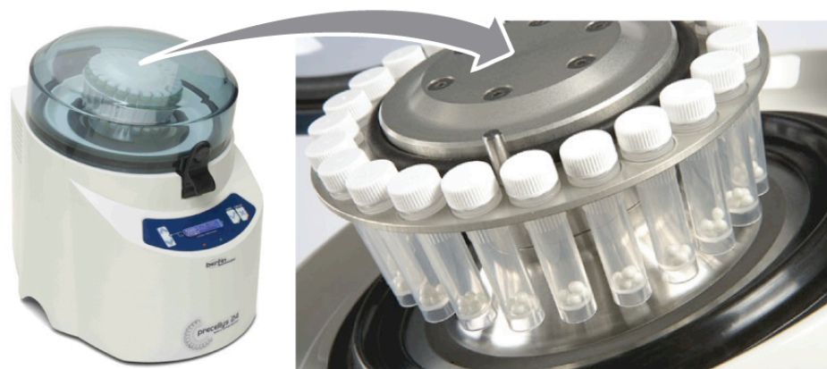
Figure 4.2 : Homogénéiseur de tissu biologique ( www.precellys.com )
