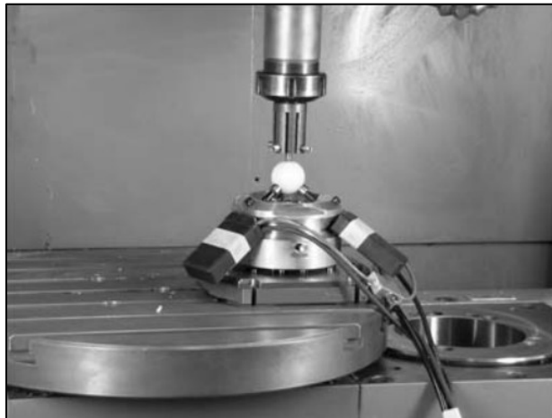
Figure 2.11 : Exemple d'un montage du R-test [Ibaraki et Knapp, 2012]
