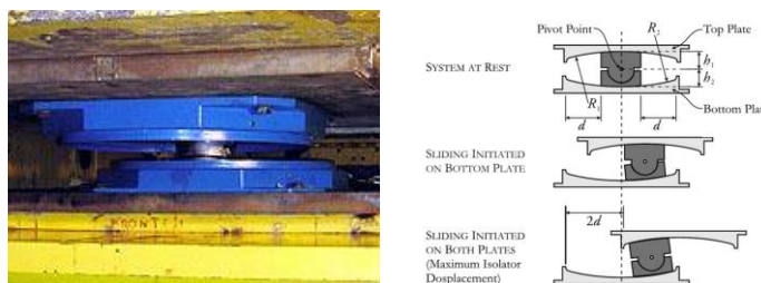
Figure 2.10: Isolateur sismique pendulaire à friction (tiré de Fenz et Constantinou, 2008)
