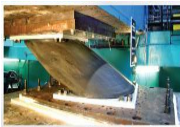
Figure 2.9: Isolateur sismique en élastomère fretté (tiré de DIS)
