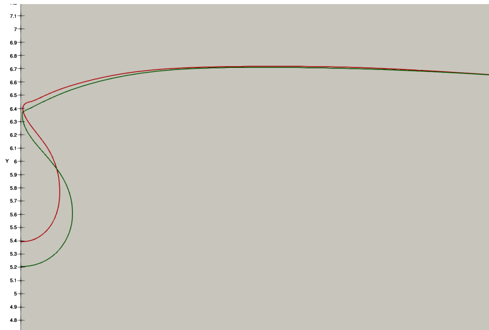
(b) Zoom de la forme de l'interface en incompressible (vert) et en compressible (rouge)
