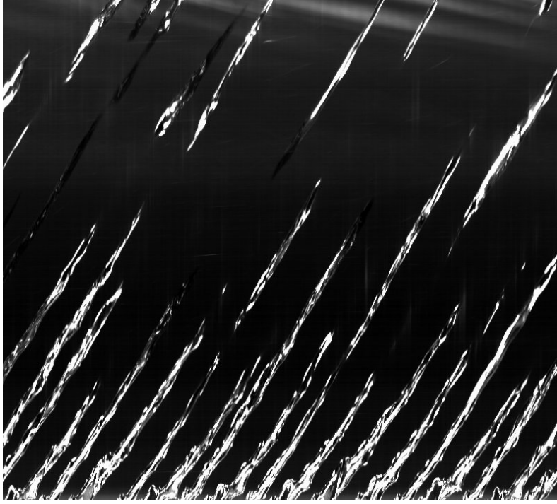
Figure 3.4 Diagramme spatio-temporel de l'évolution des bulles d'air dans l'eau. L'axe des abscisses correspond au temps, celui des ordonnées à l'axe vertical (l'accélération de la pesanteur \vec{g} est orientée de haut en bas.). Une ligne blanche correspond à la montée d'une bulle d'air vers la surface libre, la pente étant égale à sa vitesse de montée
