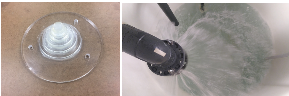
Figure 3.18 (À gauche) Cône en acrylique. (À droite) Cône installé dans le réservoir, la boucle d'essais étant en fonctionnement. Il empêche l'écoulement diphasique d'être immédiatement aspiré par la pompe
