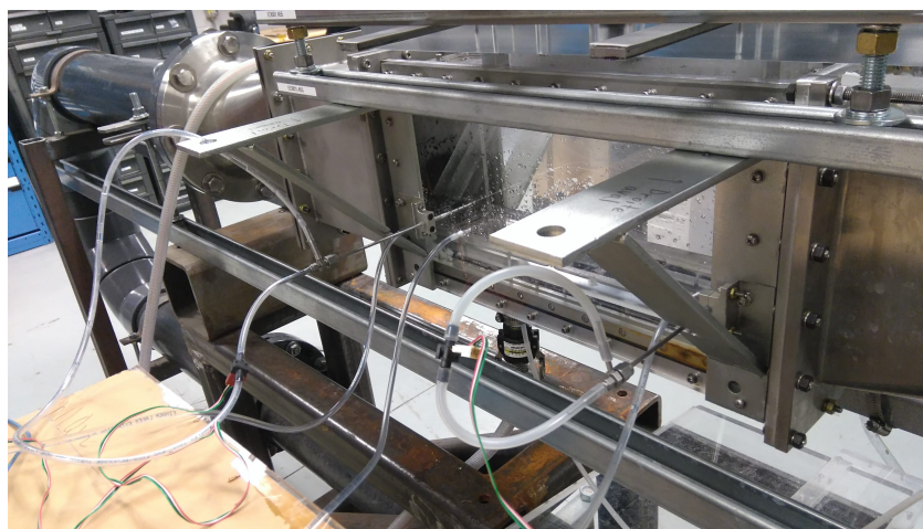
Figure 3.7 Fenêtre latérale avec les capteurs de pression
