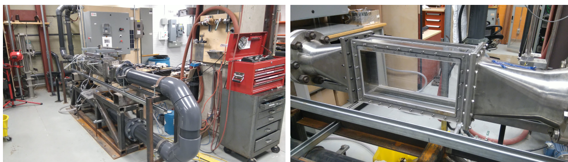
Figure 3.5 (À gauche) Boucle d'essais. (À droite) Veine d'essais, partie de la boucle où les mesures ont été faites
