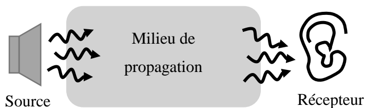
Figure 2.1 : Transmission du bruit depuis la source jusqu'au récepteur
