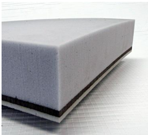
Figure 2.9 : Barrière acoustique multicouche (source : [29])
