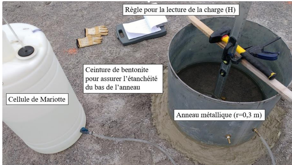
Figure 3.5 Essai d'infiltration avec la méthode du simple anneau ( r=0,3 m).
