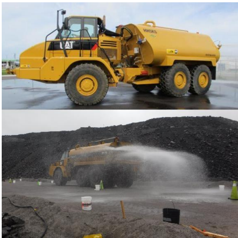
Figure 3.6 Camion-citerne utilisé pour les tests d'infiltration à grande échelle (crédit: Macallister Machinery) et photo du camion effectuant un passage d'un essai d'infiltration à grande échelle (crédit : IRME).
