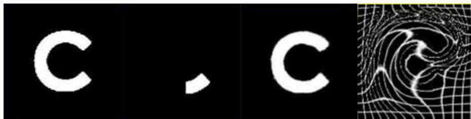
Figure 2.16 de gauche à droite : l'image cible, l'image source, l'image transformée par LDDMM, le champ de déformation résultant (Avants and Gee, 2004).
