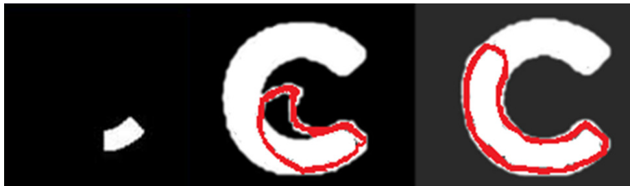
Figure 2.19 Recalage d'un patch sur une forme de C. Au milieu la moyenne euclidienne, à droite la moyenne log-euclidienne (Avants et al., 2006)
