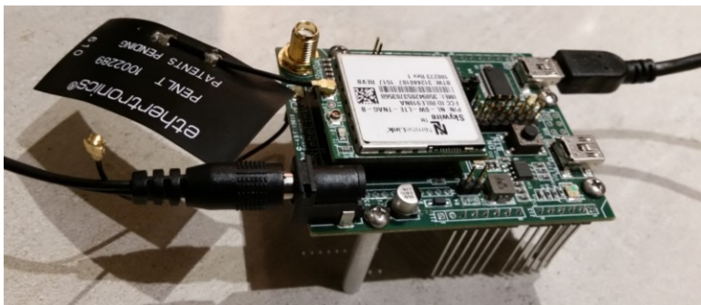
Figure 2.6: Disposition du modem avec la carte de développement
