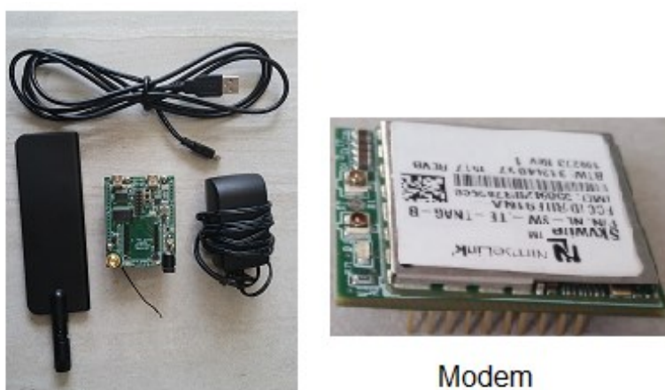
Figure 2.5: Kit de développement sans les cartes SIM et modem de NimbeLink
