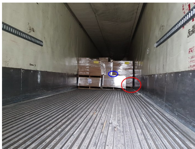
Figure 5.5: Position du dispositif durant le test en mouvement avec le camion réfrigéré
