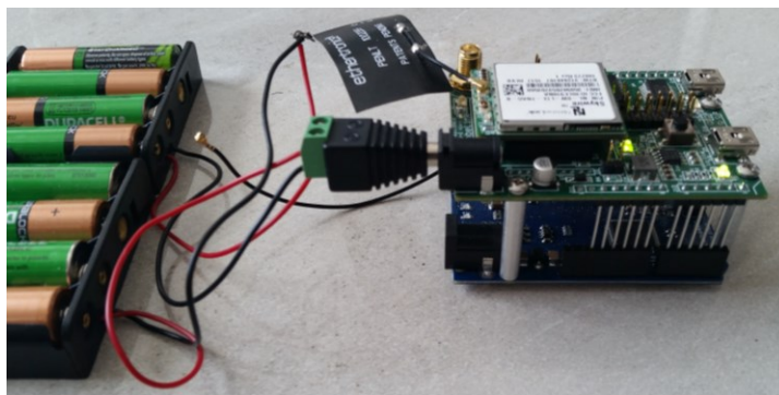
Figure 2.11: Disposition: Modem, carte de développement, l'Arduino et l'alimentation
